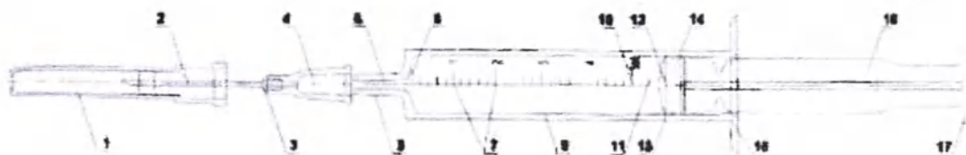
Рисунок 1- Схематическое изображение шприца инъекционного одноразового с иглой
