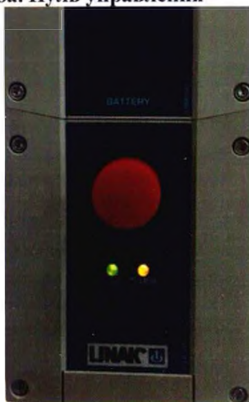
Рис. 28в. Аккумуляторная батарея во время зарядки
