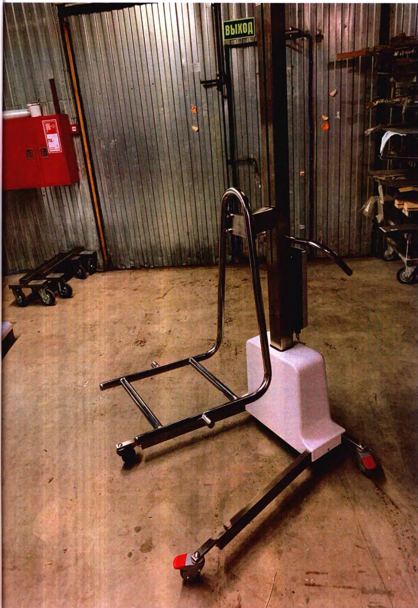
корпус подъемника с колесной рамой, блоком управления и рамой ложа
