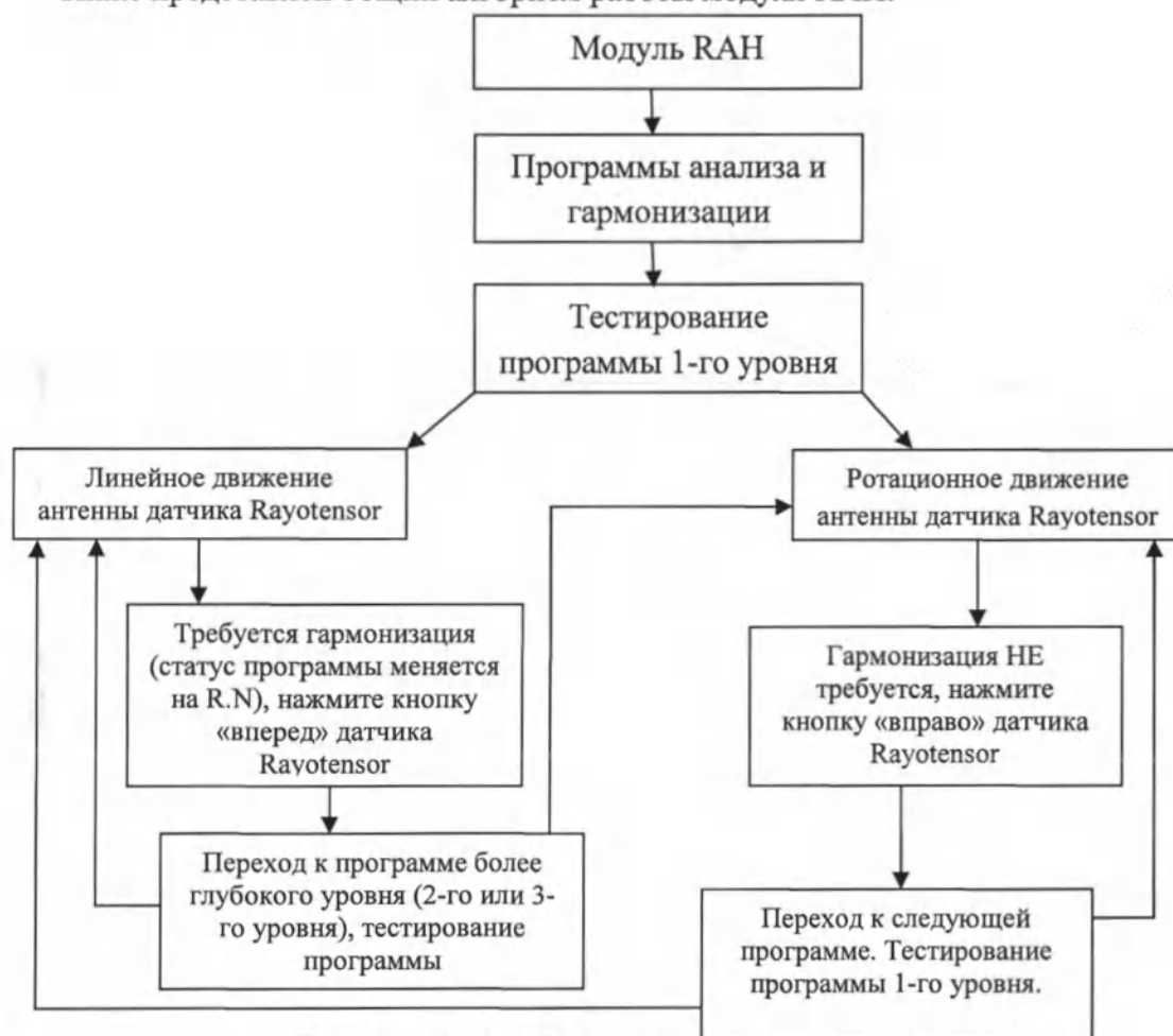
Рисунок 7.1.1– Общий алгоритм работы модуля РАН
