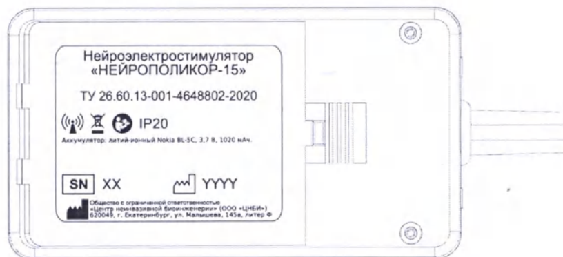
Рисунок 12 – Маркировка нижней части корпуса нейроэлектростимулятора «НЕЙРОПОЛИКОР-15»
