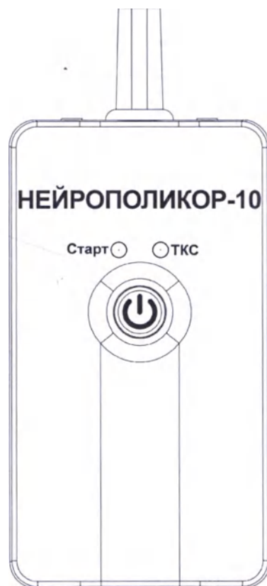
Рисунок 11 – Маркировка верхней части корпуса нейроэлектростимулятора «НЕЙРОПОЛИКОР-10»
