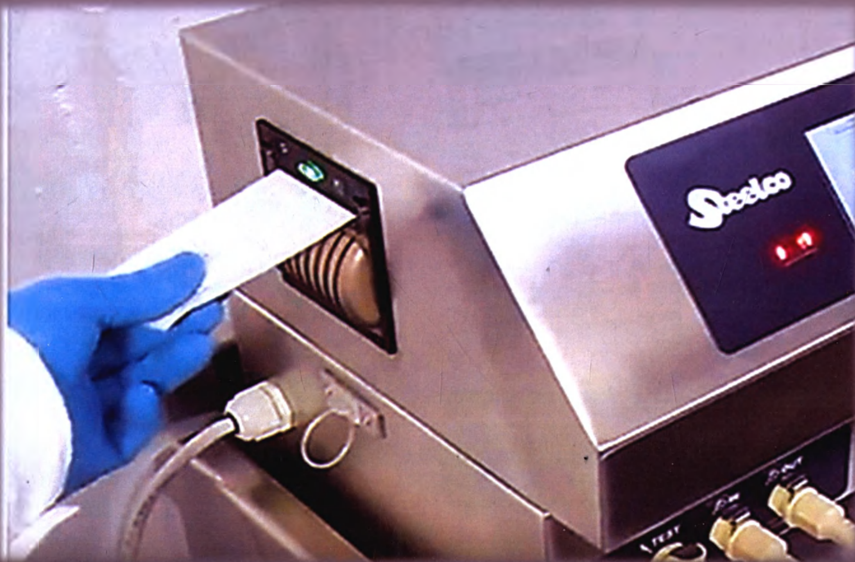
Фото 3а - Устройство предварительной очистки эндоскопов EPW 100, EPW 100 S: Бумага для распечатки данных процесса обработки
