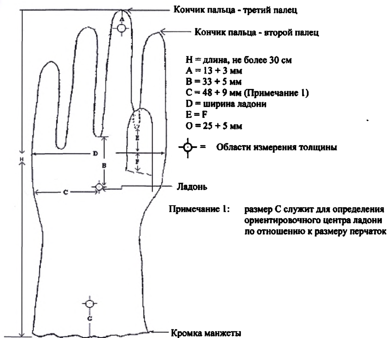
Рис. 5. Габаритные размеры перчаток диагностических полихлоропреновых
