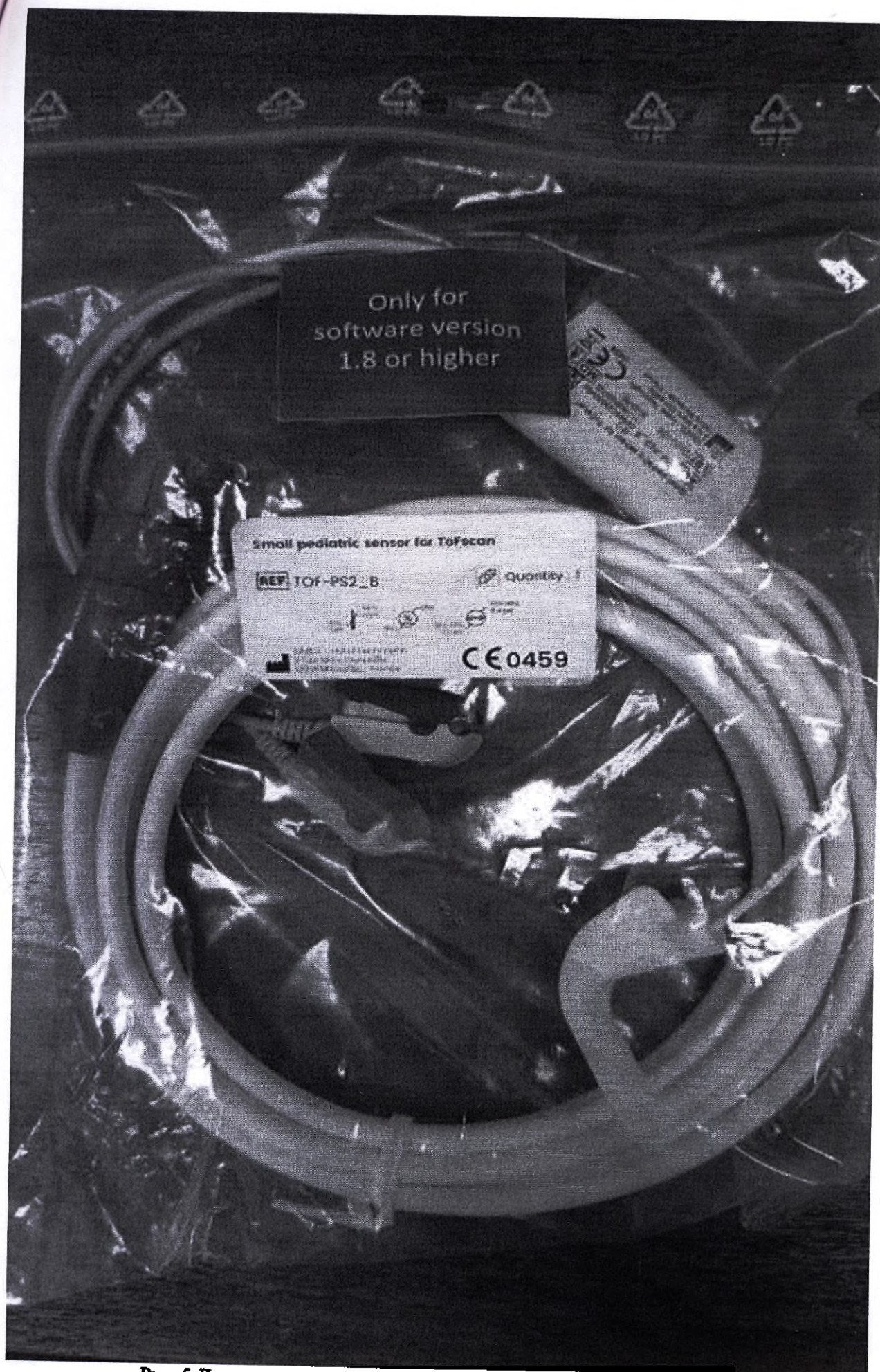
Рис. 5 Датчик пальца кисти с электродами (педиатрический малый)
