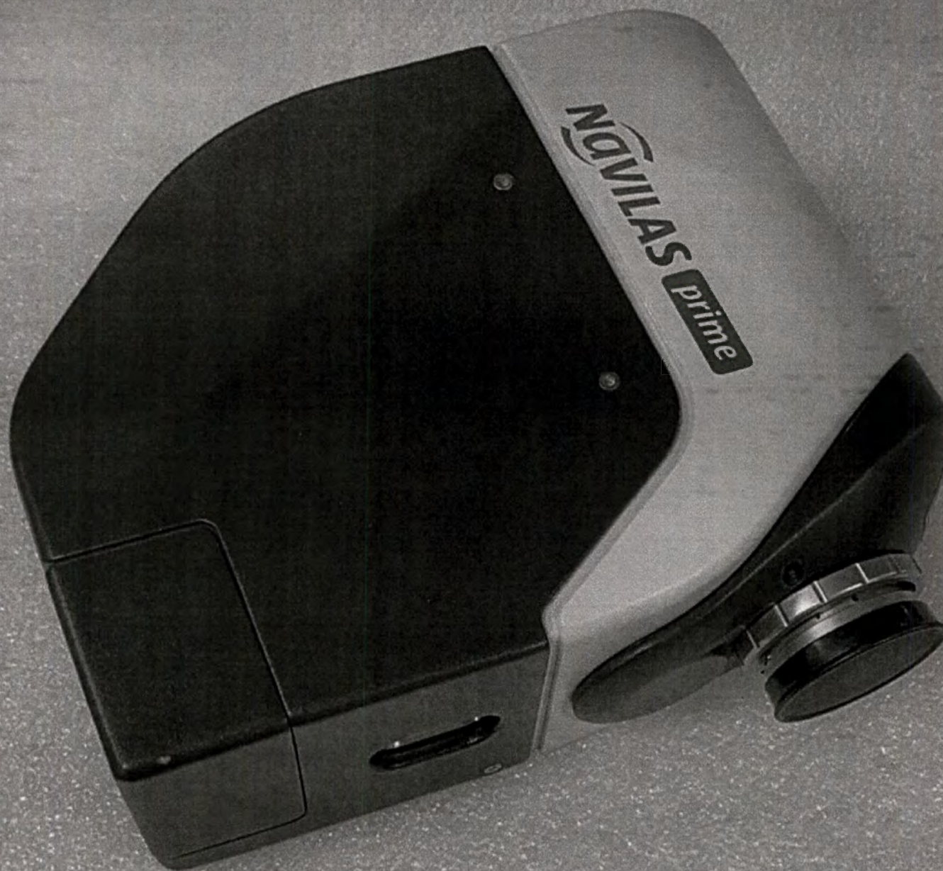
2. Оптическая голова с контактным объективом с крышкой (комплект поставки №1: конфигурация «NAVILAS prime»)
