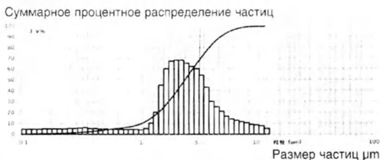
Рис. 5. Кривая распределения диаметра распыляемых частиц небулайзера в концентраторе кислородном CS-013L
