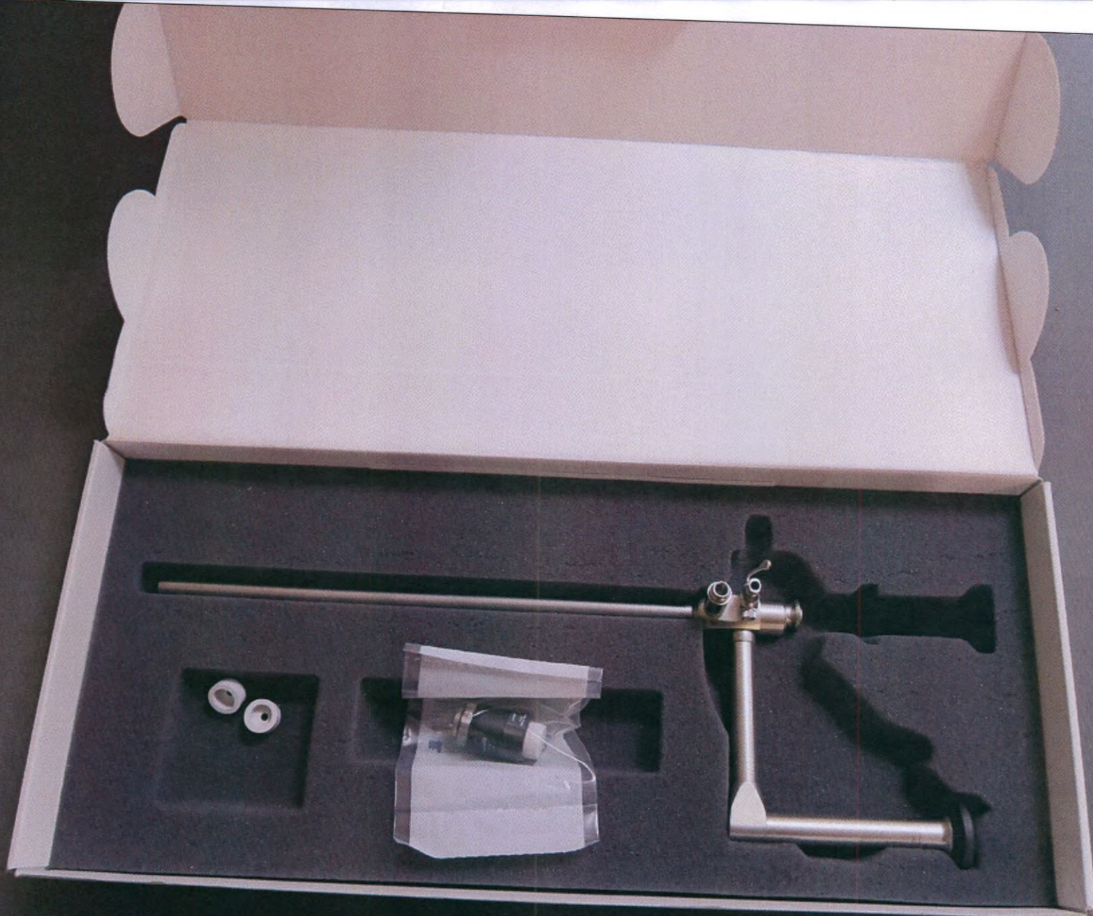
Рис. 13. Эндоскоп жесткий HOPKINS для применения при лапароскопических операциях с параллельным окуляром, с инструментальным каналом, типоразмер: направление наблюдения 0^\circ , диаметр 10 мм, длина 27 см.
