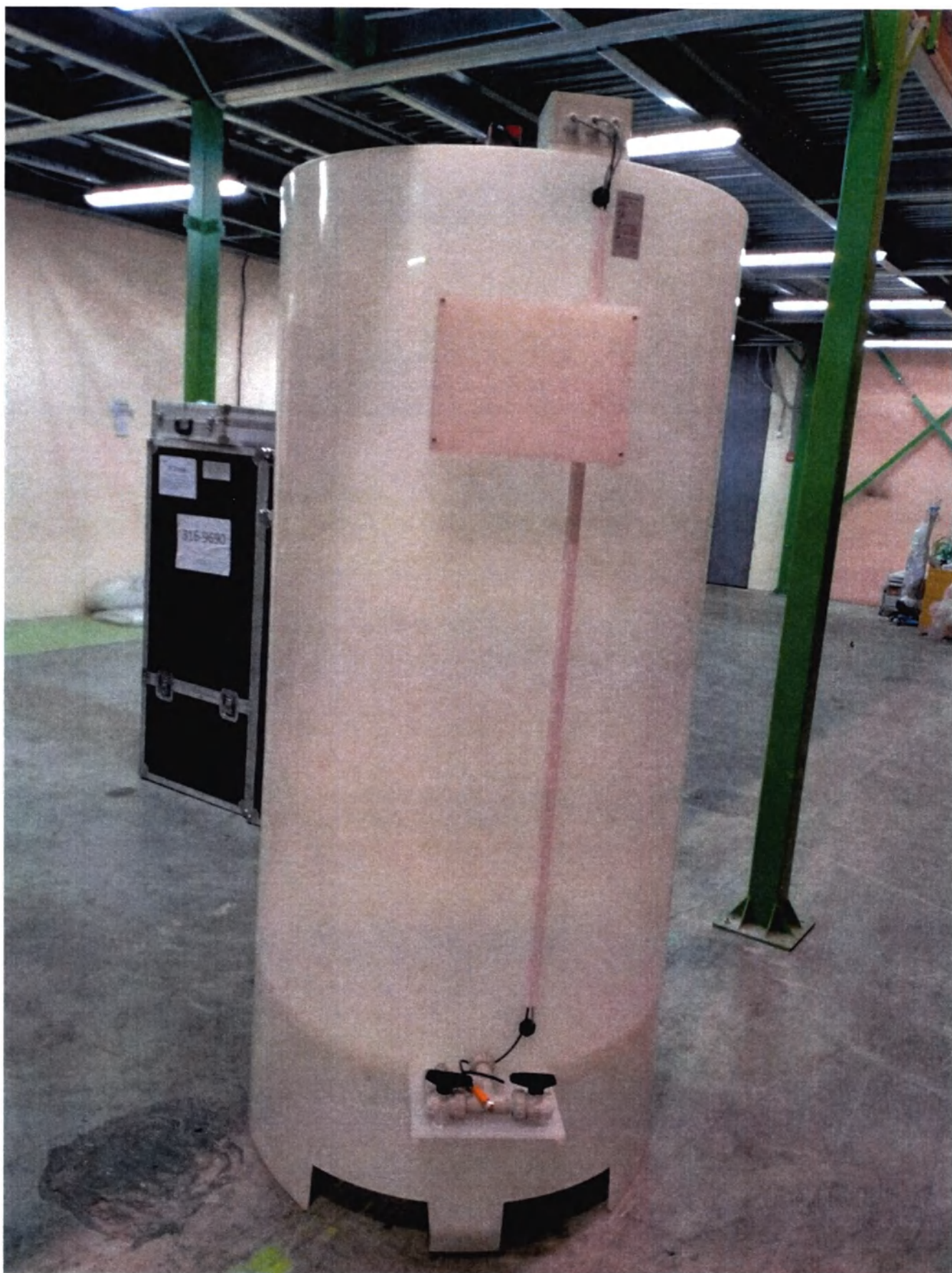
ЭКОТанк для хранения приготовленного концентрата, со стороны подключения и установки мастер-модуля
