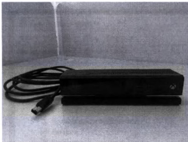
Рисунок 13. Система оптического трекинга «Kinect (сенсорный контролер)»
