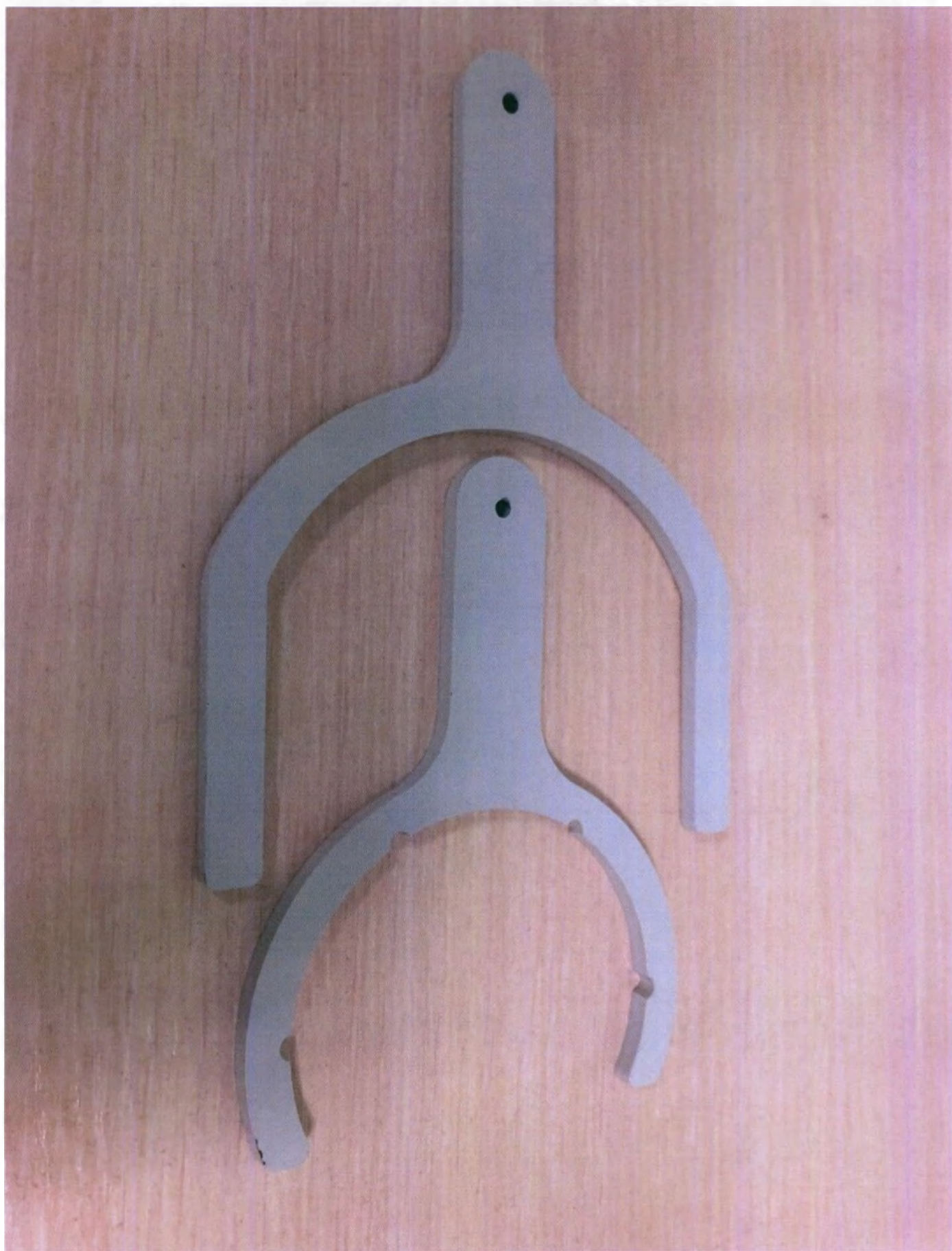
Фотография 17 - Набор ключей для контейнера для отходов: - Ключ для контейнера для отходов (155,0 мм×115,0мм×5,0мм) - Ключ для контейнера для отходов (190,0 мм×140,0мм×5,0мм)
