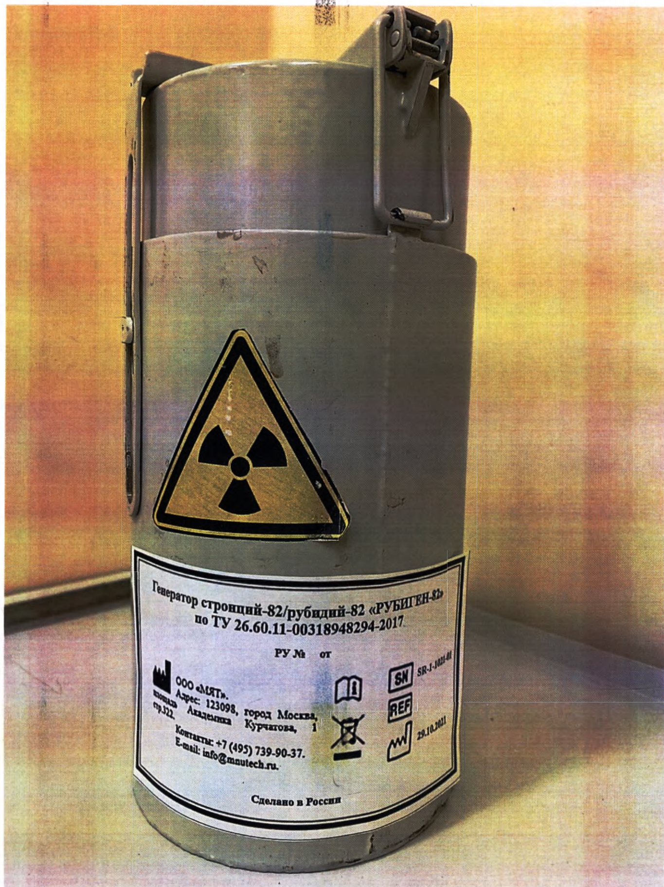
Общий вид защитного контейнера с выдвижной ручкой
