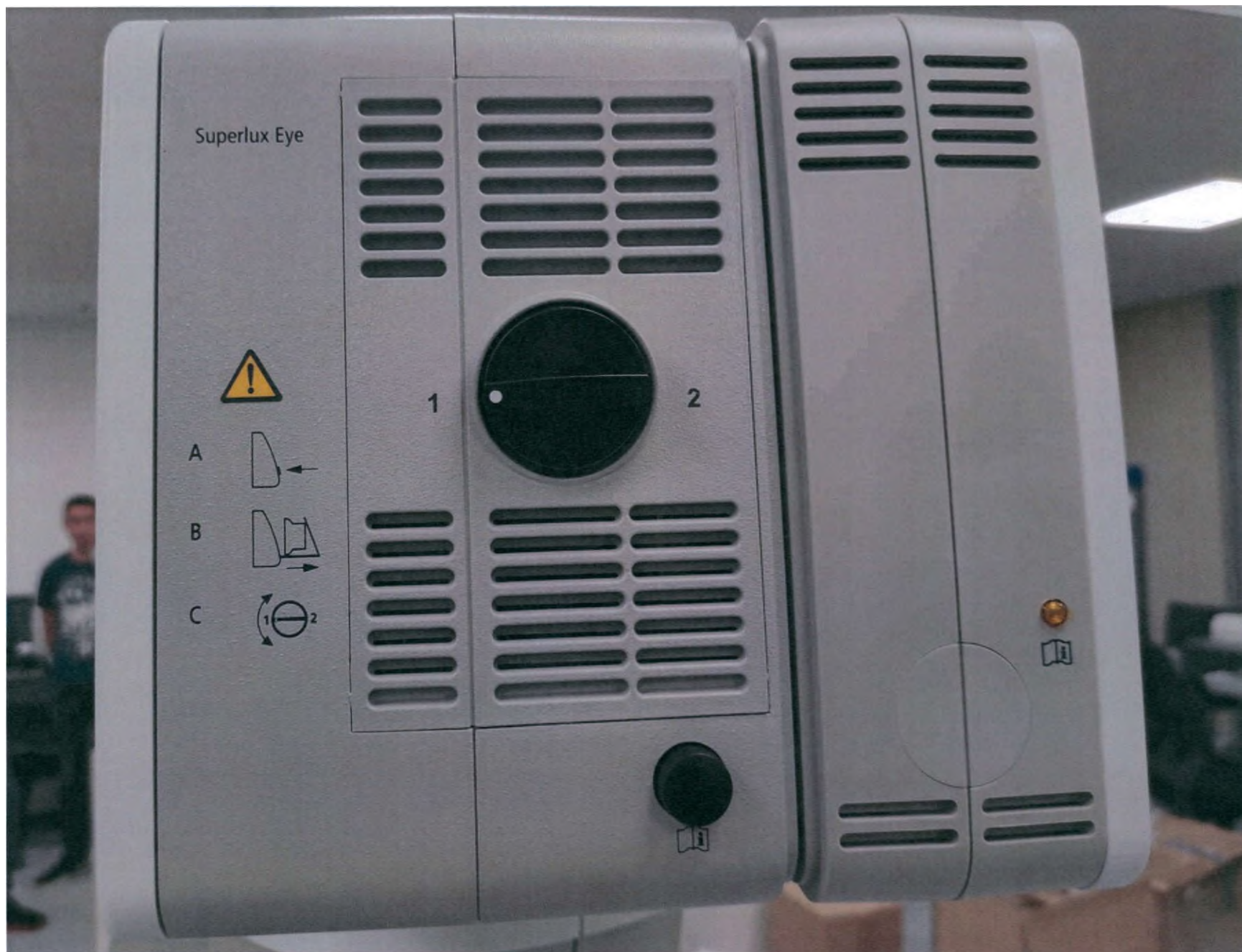
19. Основной источник света для стереокоаксиального освещения ксеноновый, или диодный, или галогенный (в кожухе справа, на примере диодного источника); дополнительный источник света ксеноновый, или диодный, или галогенный (в кожухе слева, на примере
