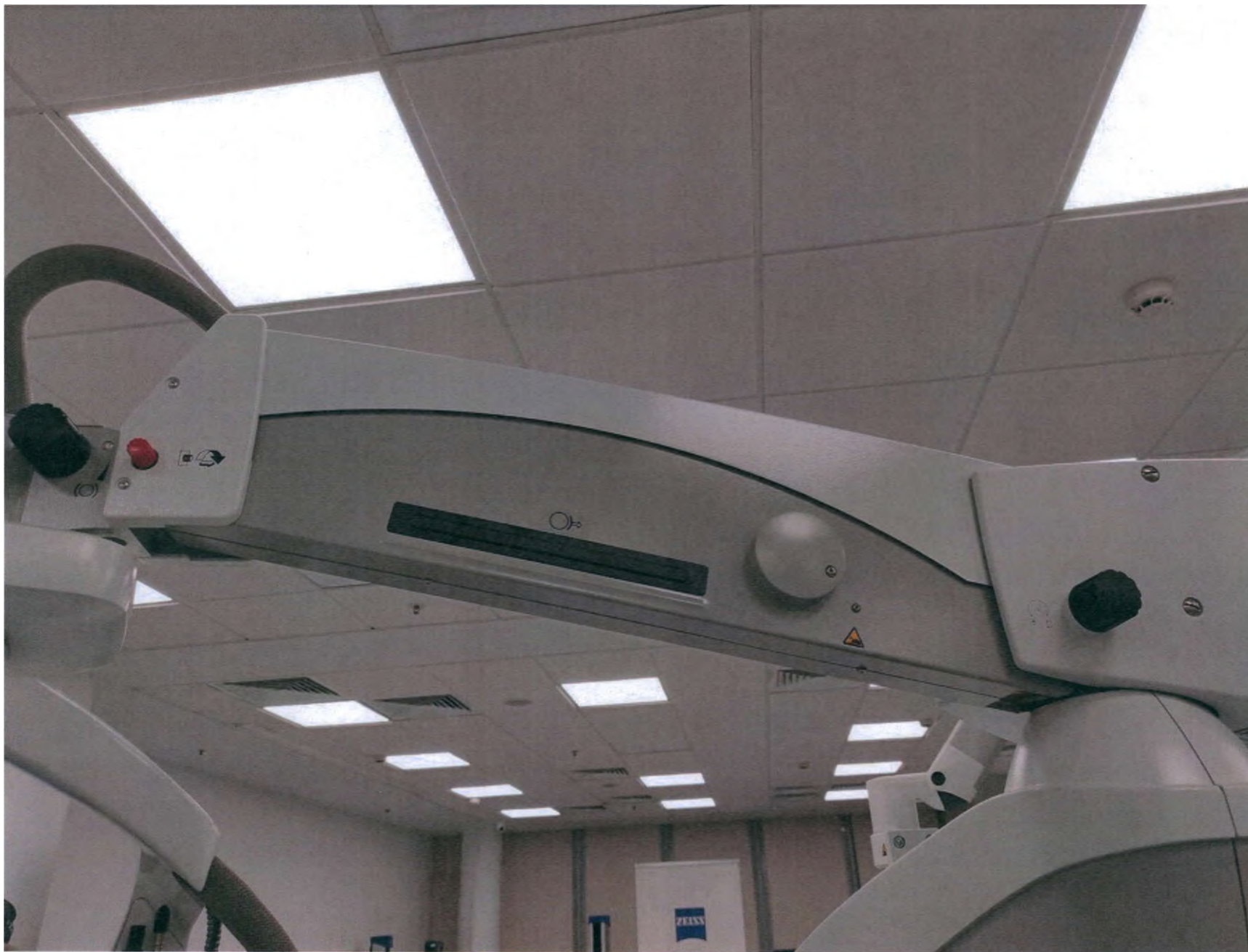
13. Основной блок микроскопа ARTEVO 800 с механизмом наклона головки моторизованным или ручным на напольном штативе – элементы управления и символы на пружинной консоли штатива.
