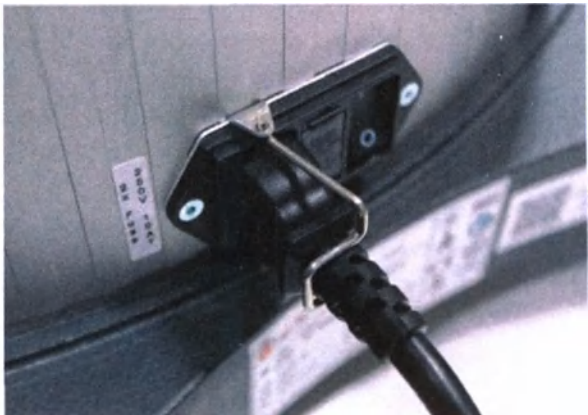
Рисунки 21 и 22. Кабель электропитания с фиксатором, прикреплённым к розетке на подъёмной колонне
