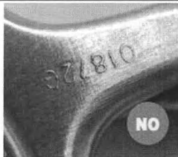
Рисунок 72.. Коррозия / Figure 72. Corrosion
