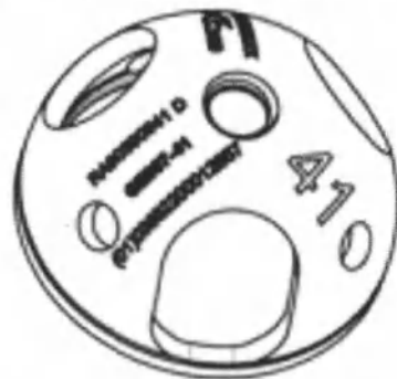
Рисунок 47 Чашки пробные диаметром от 41 мм до 69 мм с шагом 2 мм / Figure 47. Cups trial with a diameter from 41 mm to 69 mm with a step of 2 mm
