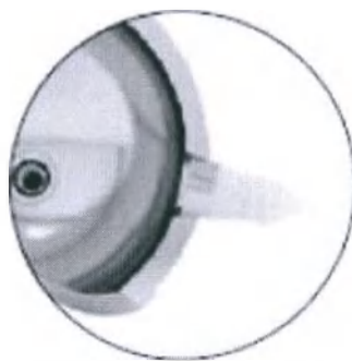
Рисунок 29 - Убедитесь, что анкерные штифты не выступают за внутреннюю поверхность / Figure 29. Check that the anchoring pegs do not stand proud of the inner surface
