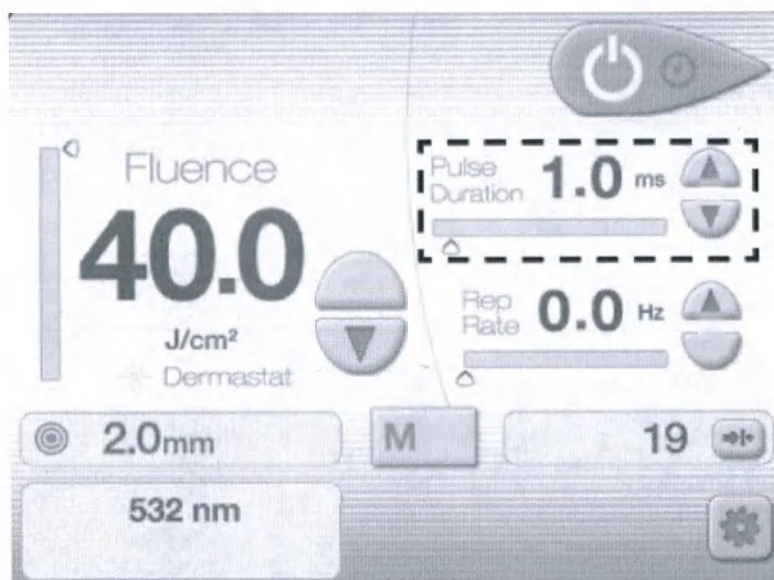
Расположение кнопок контроля и экрана длительности импульса на экране процедуры Dermastat
