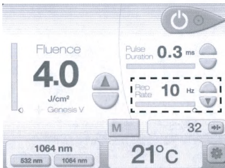
Расположение кнопок контроля и экрана частоты повторения импульса на экране процедуры Genesis V
