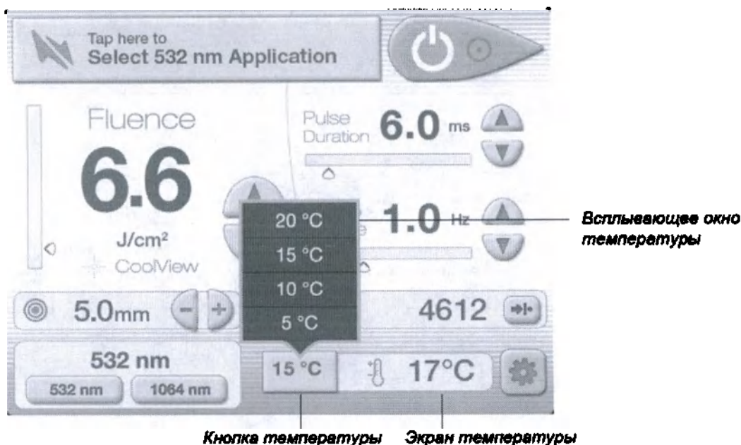
Расположение кнопки, окна и экрана температуры на экране процедуры CoolView
