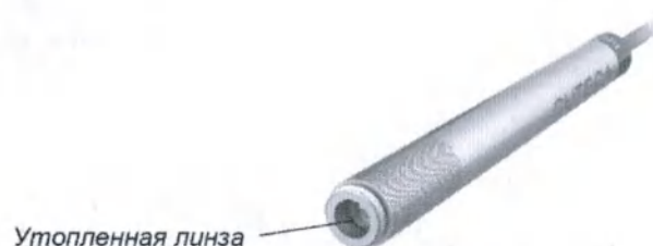
Расположение оптических поверхностей рукоятки Dermastat (колпачок рукоятки снят)
