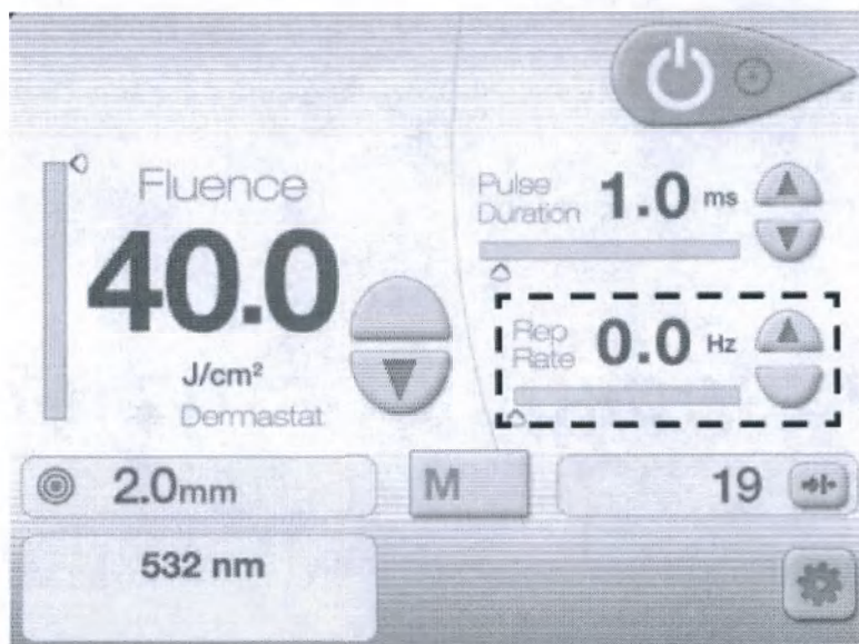
Расположение кнопок контроля и экрана частоты повторения импульса на экране процедуры Dermastat
