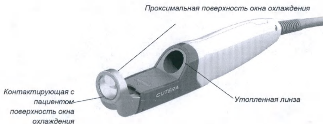
Расположение оптических поверхностей рукоятки CoolView
