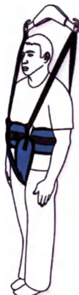
Рисунок 3.14 – схема крепления пояса поддерживающего
