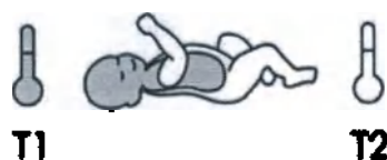
Рисунок 22 – Место крепления датчика температуры кожи.
