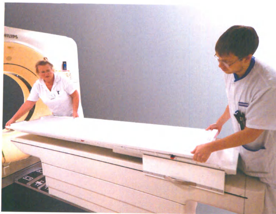
Рис. 4.6. Установка накладной панели для КТ
