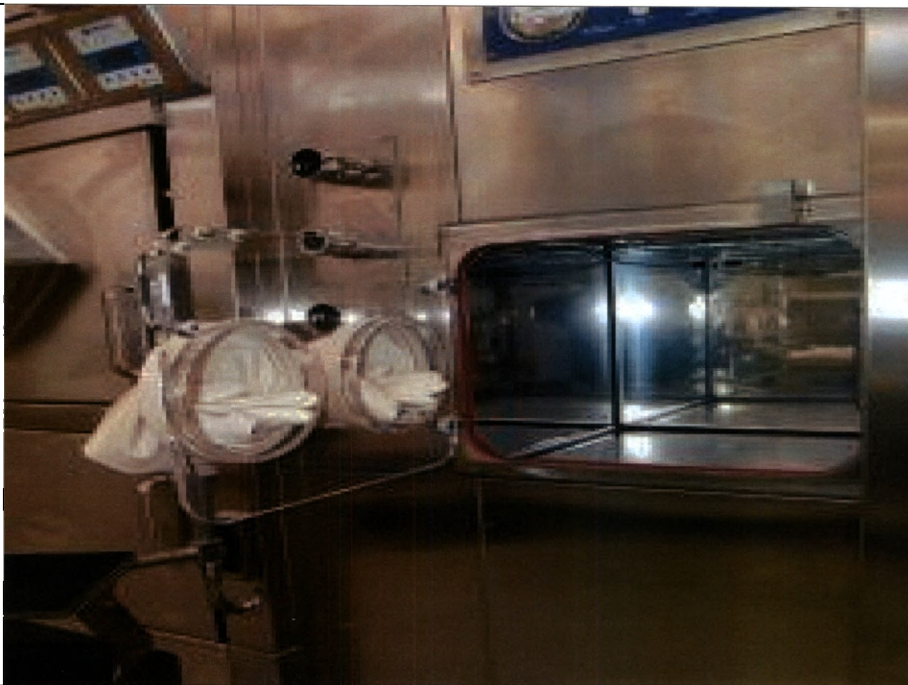
138. Камеры защитные для проведения контроля качества
