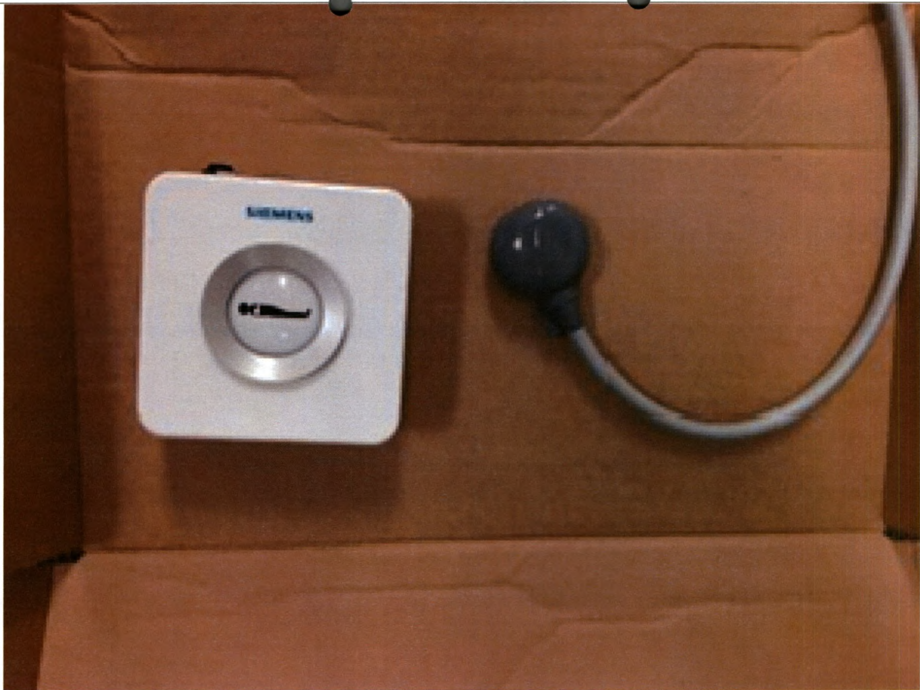
131. Кнопки вызова аварийные
