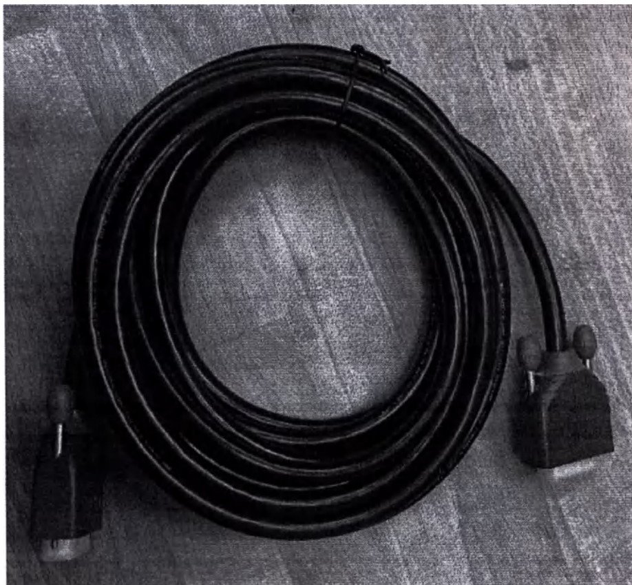
Фото 21 – Кабель DVI для получения видеосигнала с С-дуги (Поставляется отдельно)
