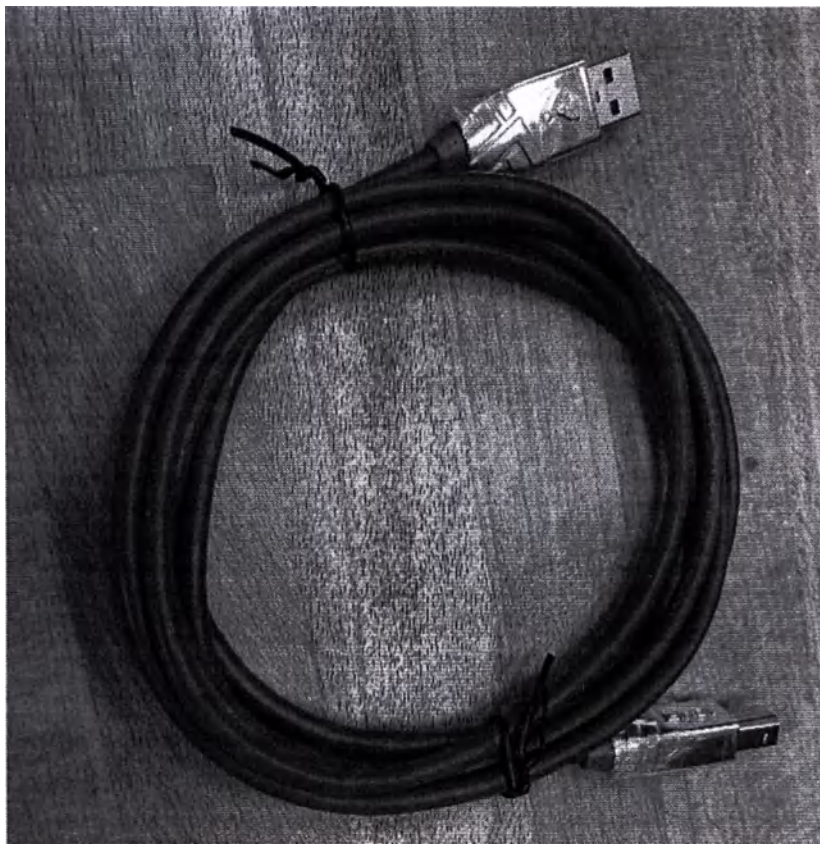
Фото 19 – USB кабель подключения дополнительного сенсорного экрана (Поставляется в сборе)
