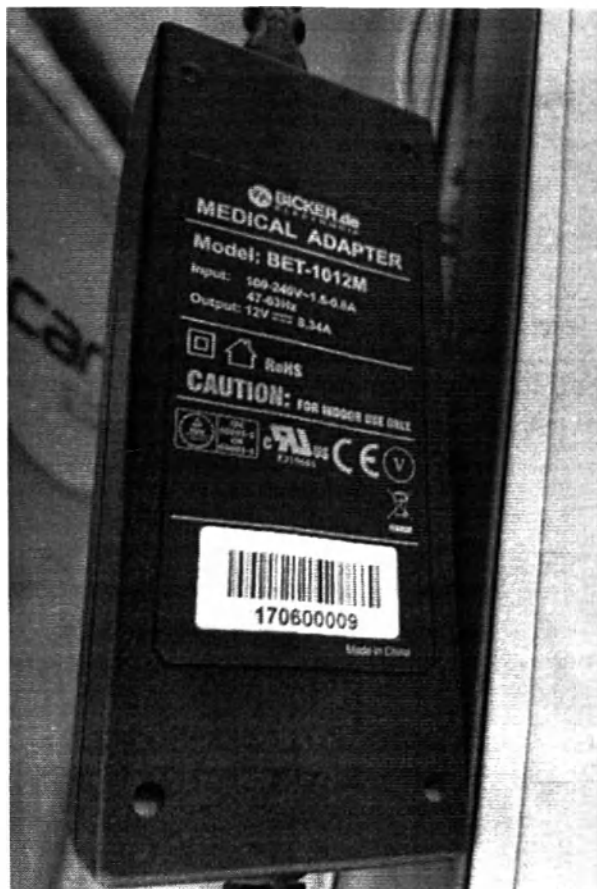
Фото 15 – Внешний блок питания для панельного компьютера ACL PC-27 (поставляется вместе с панельным компьютером)
