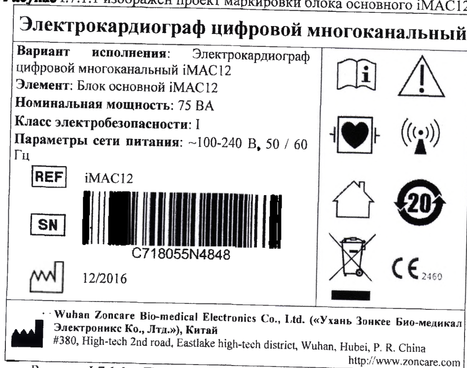
Рисунок I.7.1.1 – Проект маркировки блока основного iMAC12.
