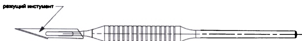
Рис. 2. Рукоятка для скальпеля ТВ-102: 1 – ручка, 2 – держатель лезвия (для установки 2х лезвий) (остальное см. рис. 1).
