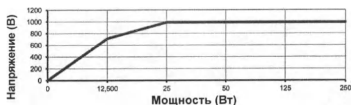
SS-501SX: Биполярное резание – максимальное пиковое напряжение в разомкнутой цепи
