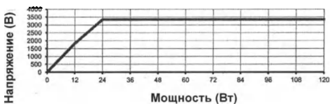
SS-501LX/SS-501SX: Фугурация (спрей) - максимальное пиковое напряжение в разомкнутой цепи
