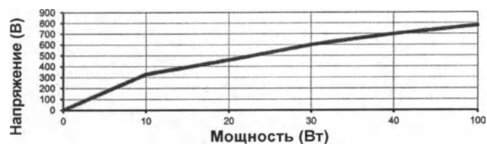
SS-501LX/SS-501SX: Микробиполярная коагуляция – максимальное пиковое напряжение в разомкнутой цепи
