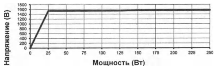
SS-501LX/SS-501SX: Смешанное резание 1 - максимальное пиковое напряжение в разомкнутой цепи (без поддержки HIGH CUT)
