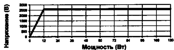
SS-501LX/SS-501SX: Форсированная коагуляция – максимальное пиковое напряжение в разомкнутой цепи
