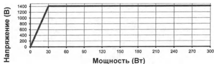
SS-501LX: Чистое резание - максимальное пиковое напряжение в разомкнутой цепи (без поддержки HIGH CUT)
