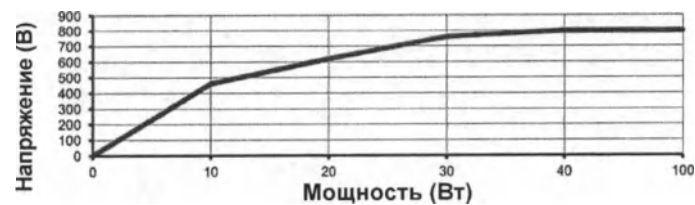
SS-501LX: Биполярная коагуляция – максимальное пиковое напряжение в разомкнутой цепи
