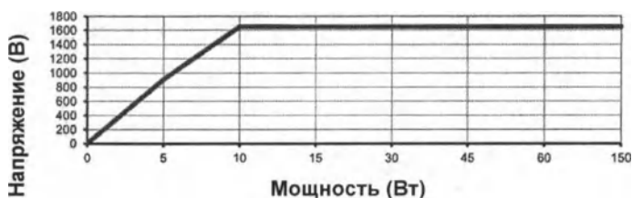
SS-501LX/SS-501SX: eCUT 3 - максимальное пиковое напряжение в разомкнутой цепи
