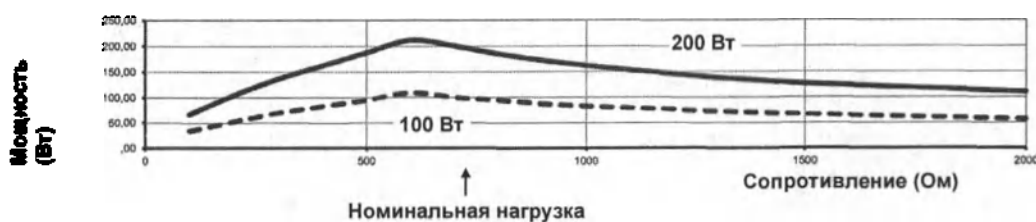
SS-501LX/SS-501SX: Смешанное резание 2 (с поддержкой HIGH CUT), зависимость мощности от сопротивления
