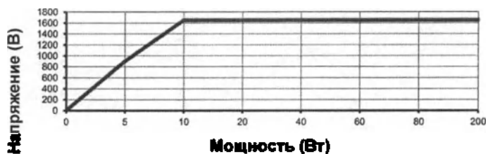
SS-501LX/SS-501SX: eCUT 2 - максимальное пиковое напряжение в разомкнутой цепи
