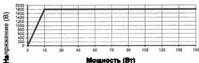
SS-501LX/SS-501SX: Смешанное резание 3 - максимальное пиковое напряжение в разомкнутой цепи (без поддержки HIGH CUT)
