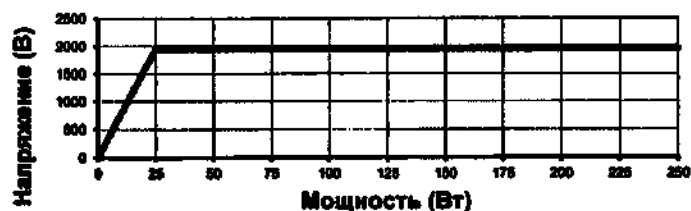
SS-501LX/SS-501SX: Смешанное резание 1 - максимальное пиковое напряжение в разомкнутой цепи (с поддержкой HIGH CUT)
