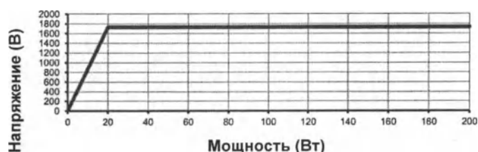
SS-501LX/SS-501SX: Смешанное резание 2 - максимальное пиковое напряжение в разомкнутой цепи (без поддержки HIGH CUT)
