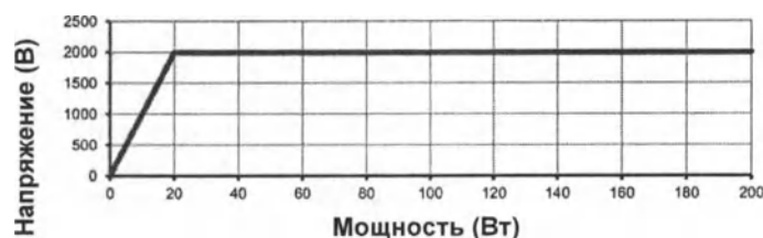
SS-501LX/SS-501SX: Смешанное резание 2 - максимальное пиковое напряжение в разомкнутой цепи (с поддержкой HIGH CUT)
