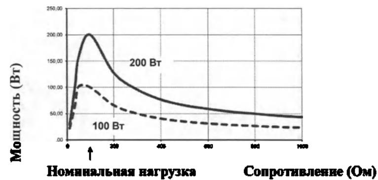
SS-501SX: Биполярная коагуляция, зависимость мощности от сопротивления
