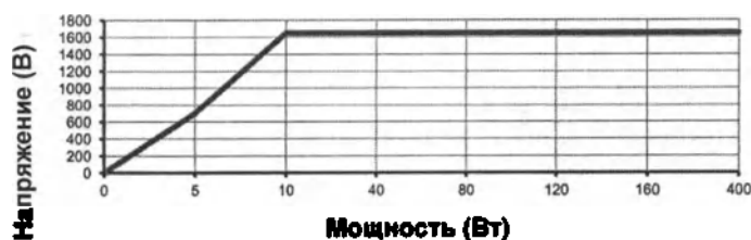
SS-501SX: eCUT - максимальное пиковое напряжение в разомкнутой цепи
