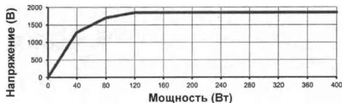
SS-501SX: Чистое резание - максимальное пиковое напряжение в разомкнутой цепи (с поддержкой HIGH CUT)
