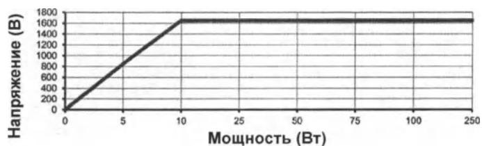
SS-501LX/SS-501SX: eCUT 1 - максимальное пиковое напряжение в разомкнутой цепи
