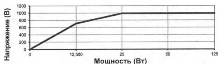
SS-501LX: Биполярное резание – максимальное пиковое напряжение в разомкнутой цепи
