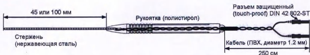
Рис. 23. Электрод-зонд стимулирующий биполярный концентрический с длиной стержня 45 мм или 100 мм; артикулы: SI2C0045S2526DRU, SI2C0100S2526DRU
