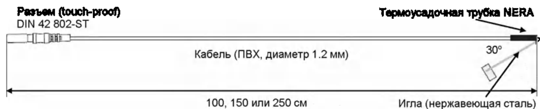
Рис. 10. Электроды игольчатые подкожные монополярные с длиной иглы 13 мм, диаметром иглы 0.40 мм, углом наклона иглы 30° (150°), с кабелем длиной 100 см или 150 см, или 250 см; артикулы: MN4013HD10SRU, MN4013HD15SRU, MN4013HD25SRU
