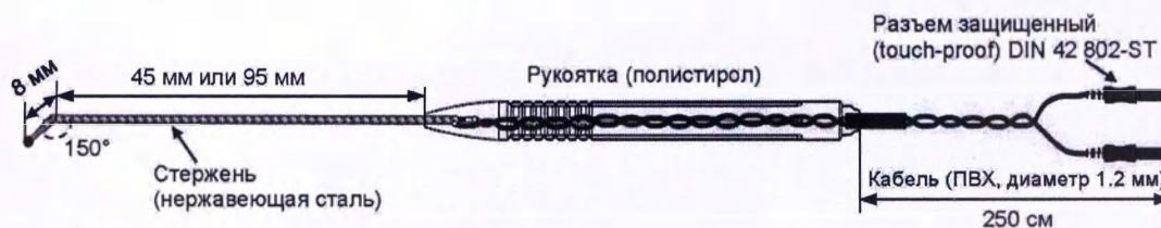
Рис. 27. Электрод-зонд стимулирующий биполярный сферический концентрический Г-образный с длиной стержня 130 мм; артикул: SI2TB130S2526DRU
