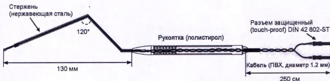
Рис. 17. Электрод-зонд стимулирующий биполярный мини-вилка Г-образный с длиной стержня 130 мм; артикул: SI2FB130S2526DRU
