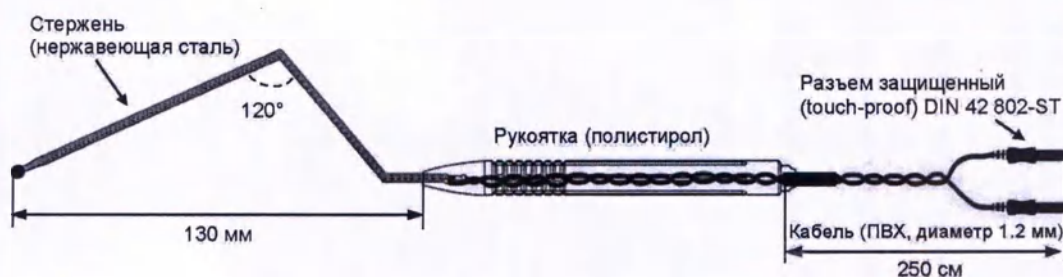
Рис. 27. Электрод-зонд стимулирующий биполярный сферический концентрический Г-образный с длиной стержня 130 мм; артикул: SI2TB130S2526DRU
