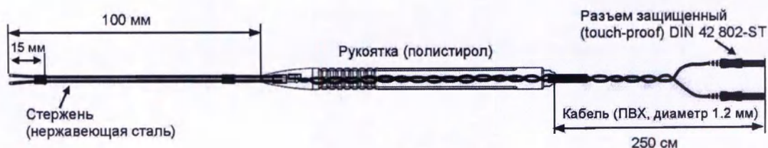
Рис. 14. Электрод-зонд стимулирующий монополярный с гибким наконечником с длиной стержня 95 мм; артикул: SI1IF095S2526DRU
