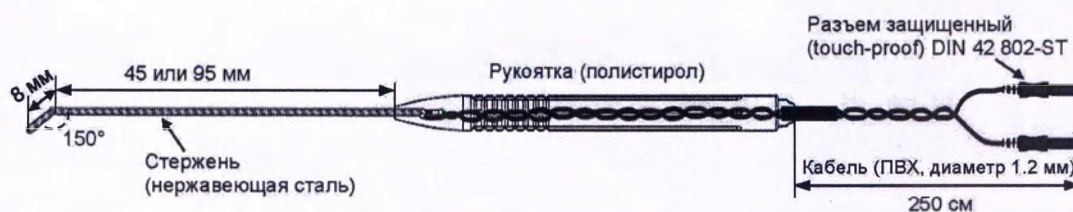
Рис. 25. Электрод-зонд стимулирующий биполярный концентрический изогнутый с длиной стержня 45/8 мм или 95/8 мм; артикулы: SI2CC045S2526DRU, SI2CC095S2526DRU
