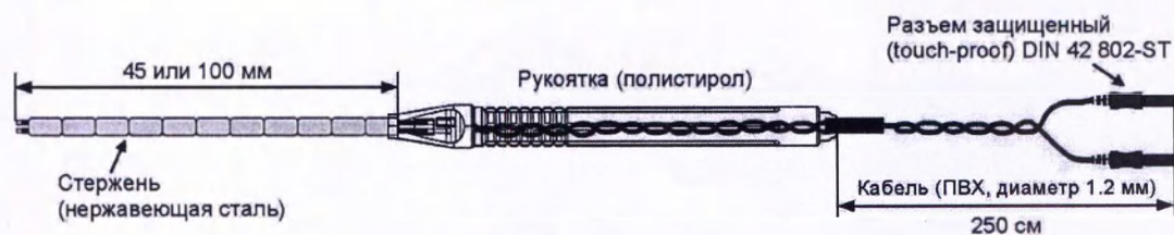
Рис. 16. Электрод-зонд стимулирующий биполярный мини-вилка с длиной стержня 45 мм или 100 мм; артикулы: SI2F0045S2526DRU, SI2F0100S2526DRU
