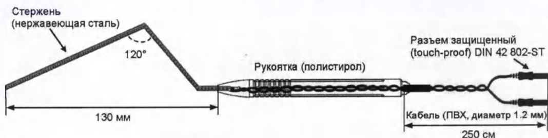
Рис. 24. Электрод-зонд стимулирующий биполярный концентрический Г-образный с длиной стержня 130 мм; артикул: SI2CB130S2526DRU
