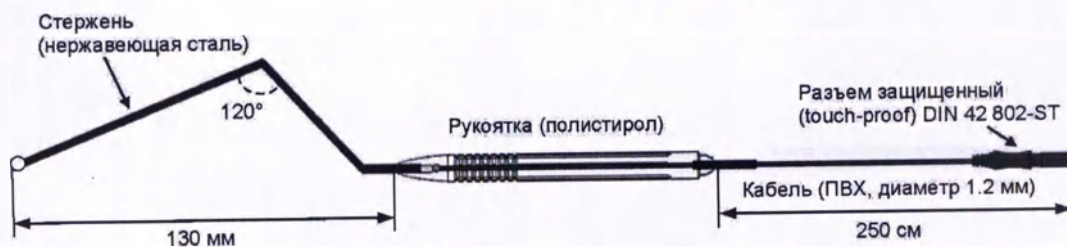
Рис. 10. Электрод-зонд стимулирующий монополярный сферический Г-образный с длиной стержня 130 мм; артикул: SI1BB130S2526DRU
