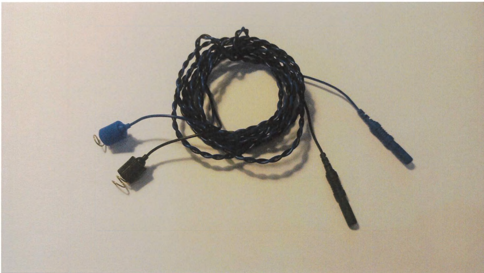
Электрод игольчатый штопорный двукратно скрученный, без экрана, с длиной иглы 5 мм, диаметром иглы 0.60 мм, с кабелем длиной 150 см, артикул MNCS0615DTSRU
