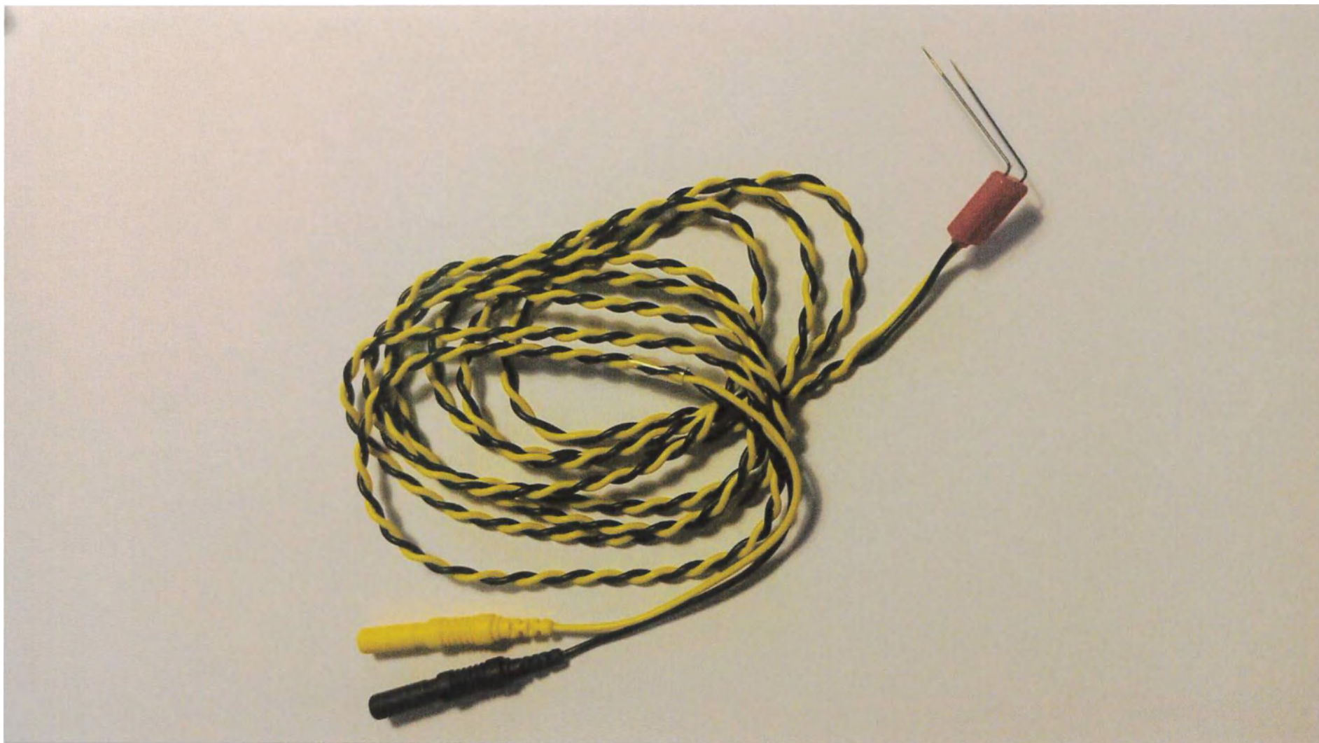
Электрод игольчатый парный скрученный с длиной иглы 25 мм, диаметром иглы 0.45 мм с углом наклона иглы 90° и расстоянием между иглами 5 мм, с кабелем длиной 150 см, артикул TFDN452541RU
