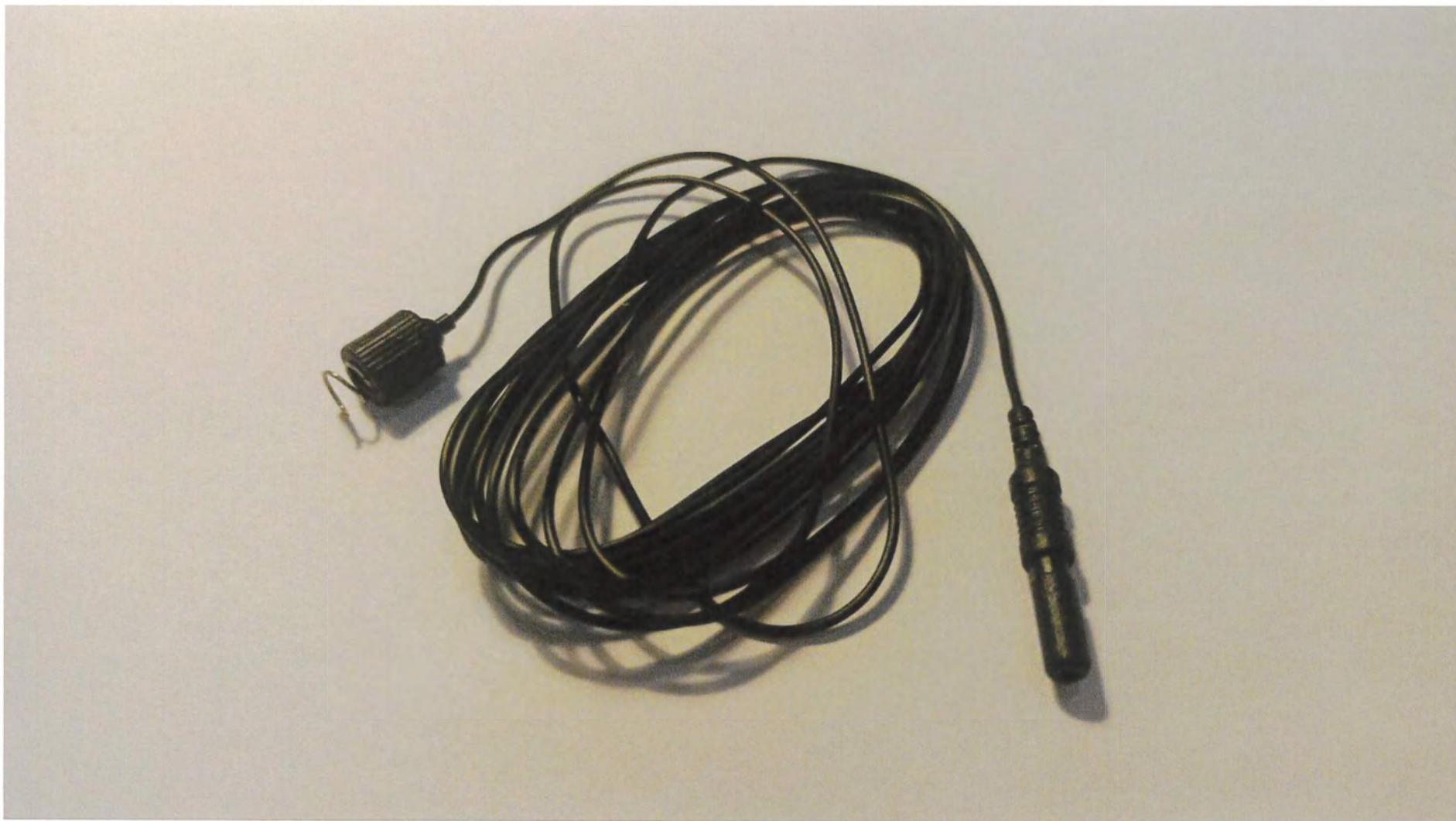
Электрод игольчатый штопорный, без экрана, с длиной иглы 5 мм, диаметром иглы 0.60 мм, с кабелем длиной 250 см, артикул MNCS0625DSRU
