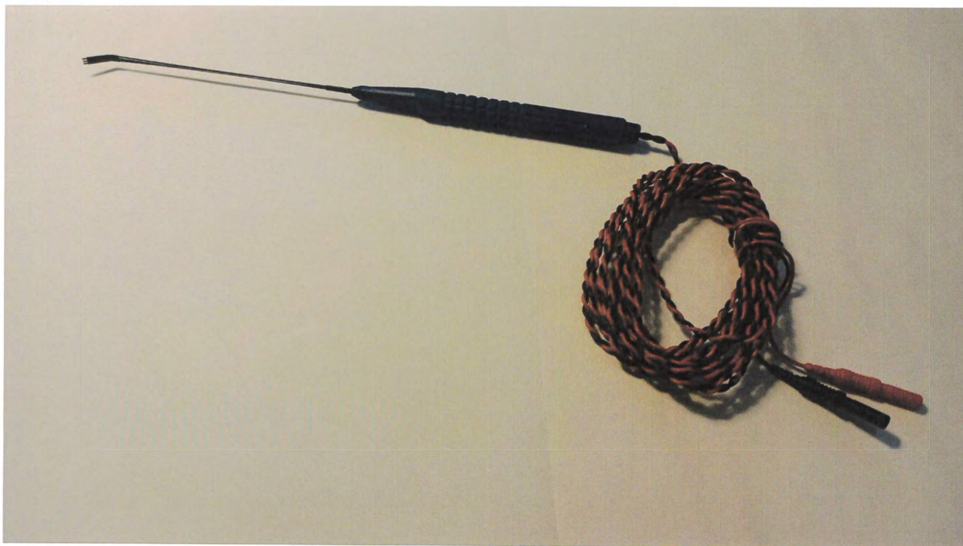
Электрод-зонд стимулирующий триполярный мини-вилка изогнутый педиатрический с длиной стержня 95/8 мм, артикул SI3FC095S2526DRU
