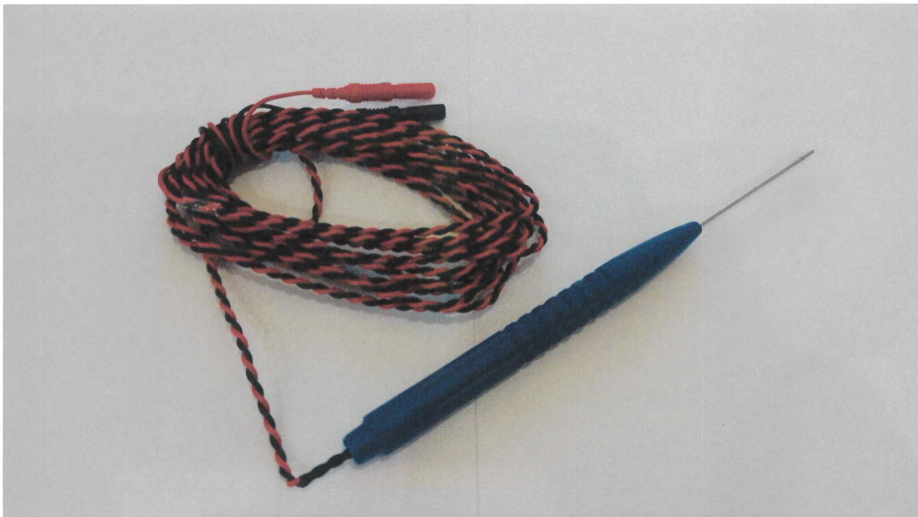
Электрод-зонд стимулирующий биполярный концентрический с длиной стержня 45мм, артикул SI2C0045S2526DRU
