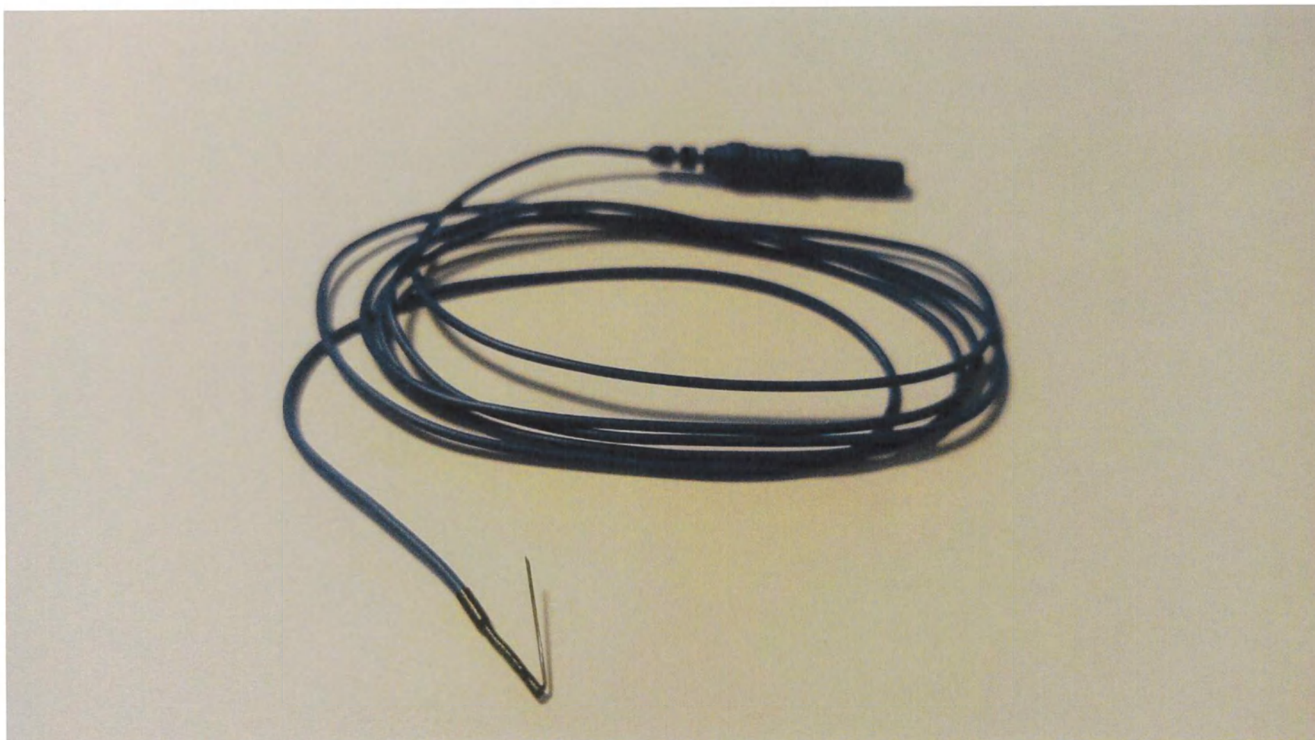
Электрод игольчатый подкожный монополярный с длиной иглы 13 мм, диаметром иглы 0.40 мм, углом наклона иглы 30° (150°), с кабелем длиной 100 см, артикул MN4013HD10SRU
