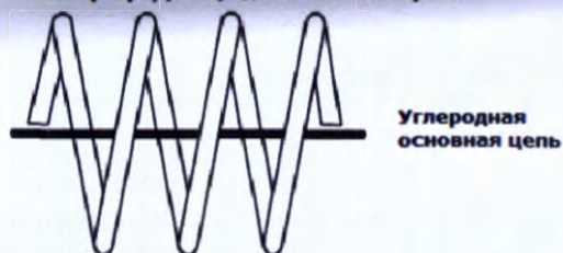
Конфигурация атомов фтора вокруг центральной углеродной (С-С)
