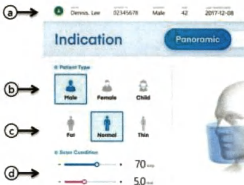
Рисунок 71. Общее меню(Panoramic(Панорамное), CT (КТ) или Model (Сканирование модели))
