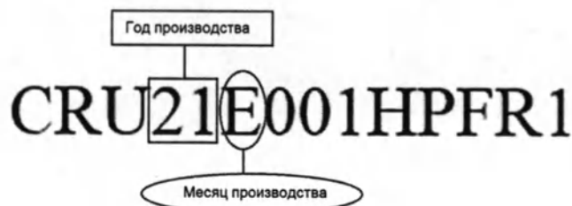
Рисунок 13. Расшифровка даты изготовления в серийном номере манипул
