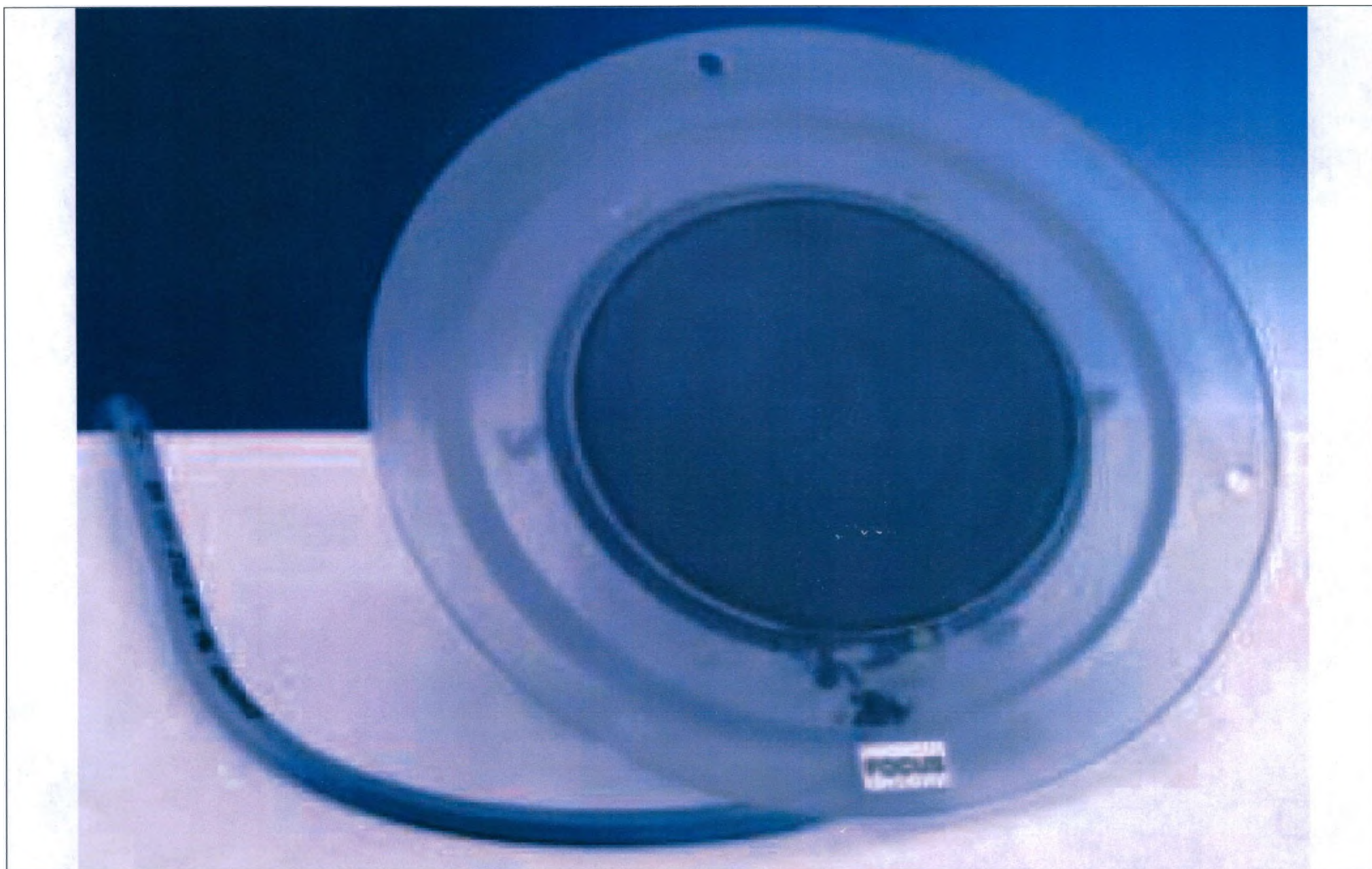
18.3 Камера для измерения дозы DIAMENTOR K1S.
