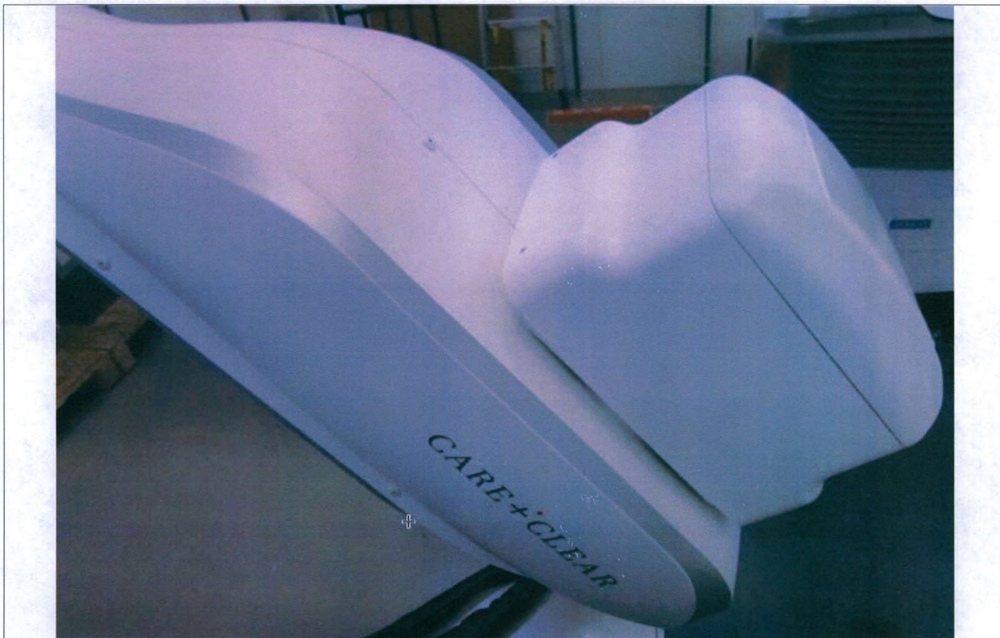
2. Блок рентгеновской трубки с первичным коллиматором.
