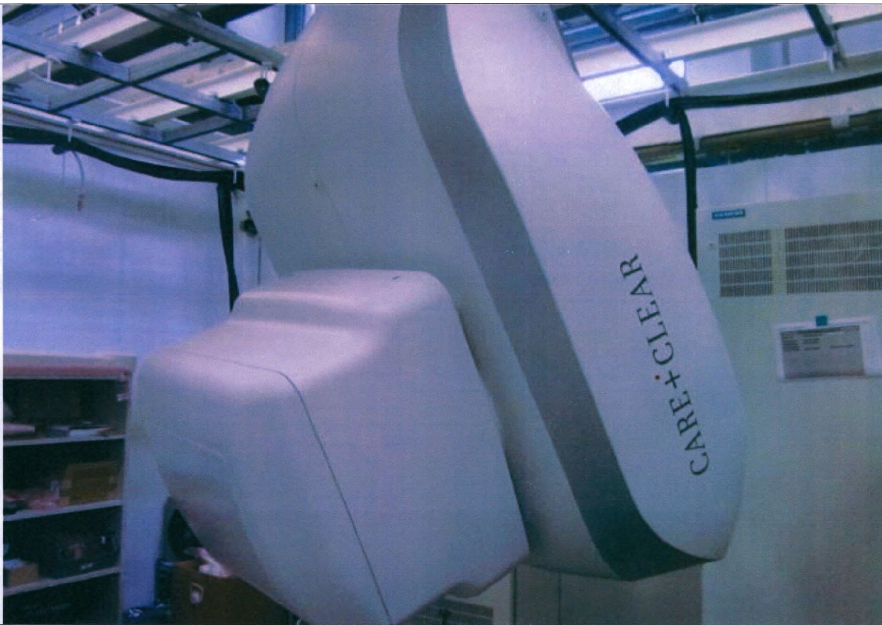
3.2 Блок рентгеновской трубки с первичным коллиматором.
