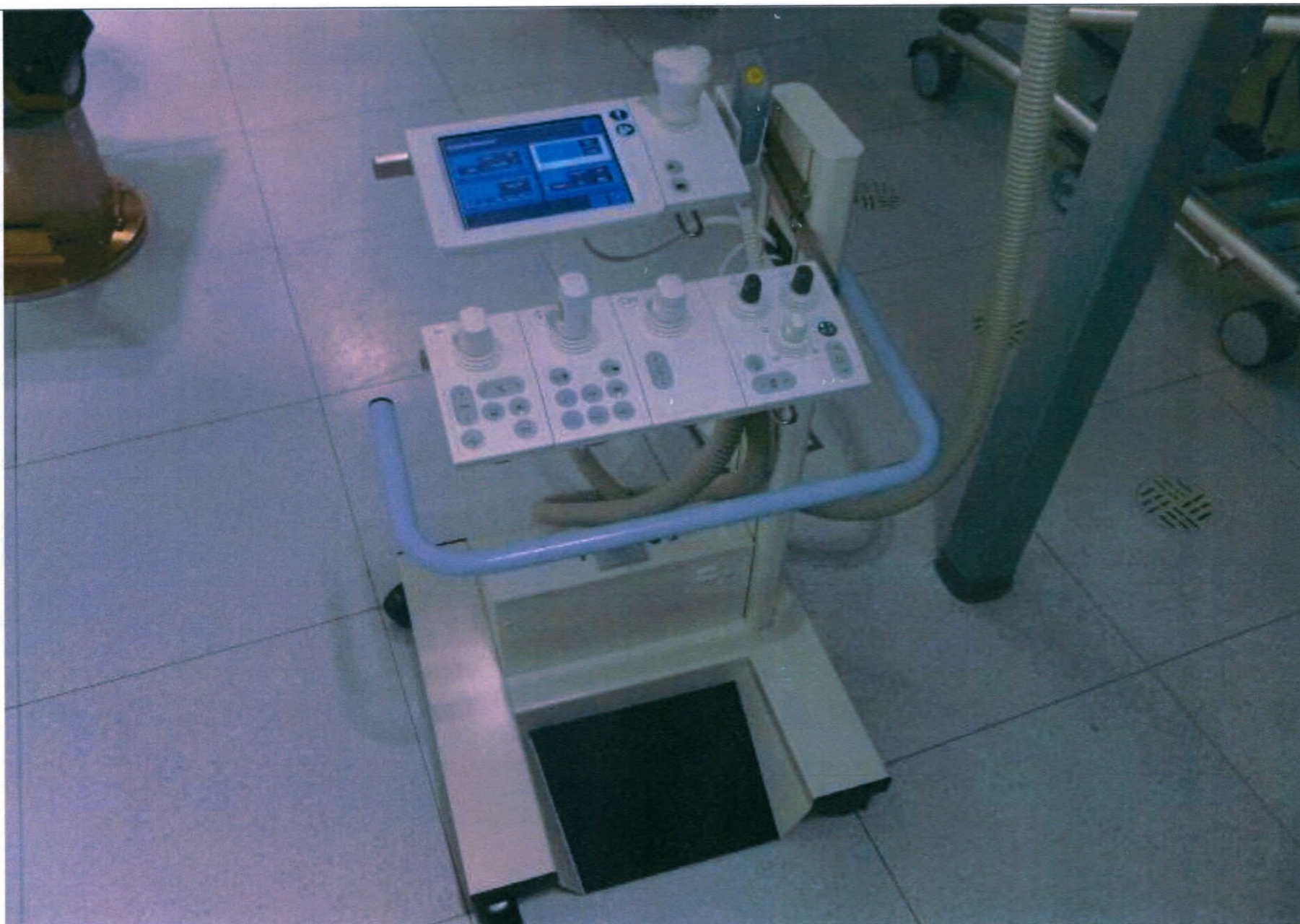
18.3 Комплект интеграции хирургического стола для систем Artis: тележка для модулей управления.
