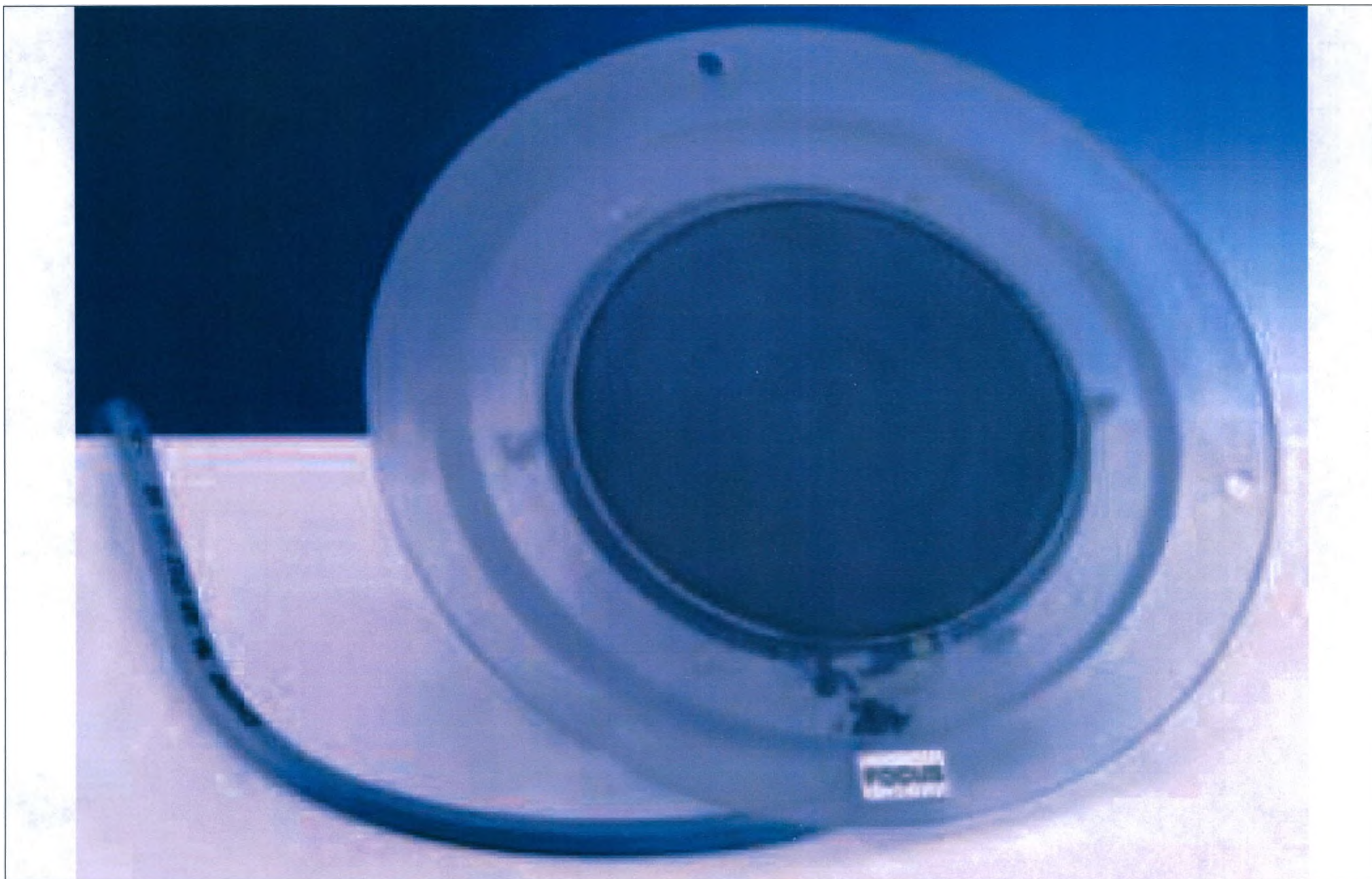
15.3 Камера для измерения дозы DIAMENTOR K2S.
