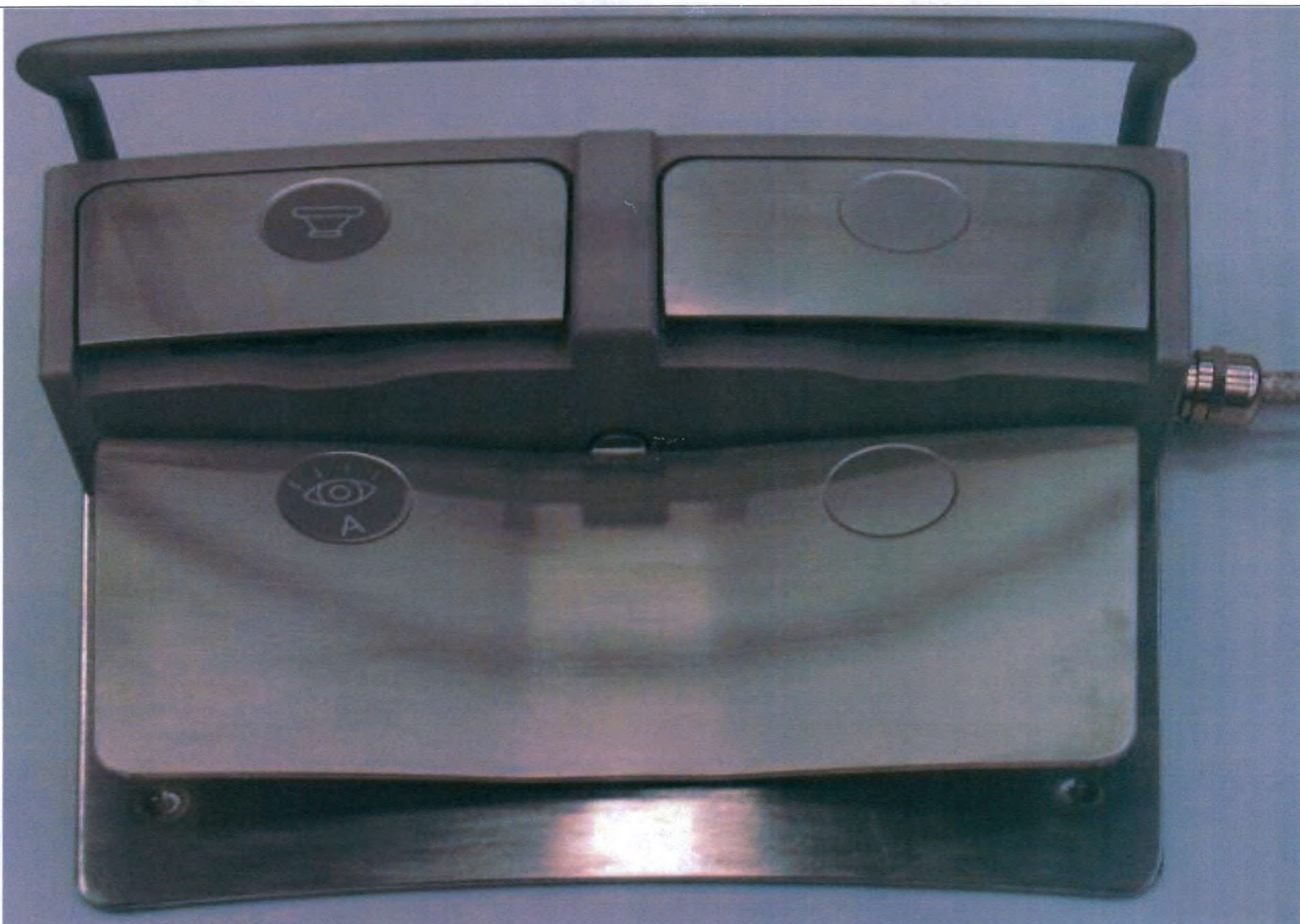
76. Педальный переключатель для включения излучения дополнительный в пультовой.
