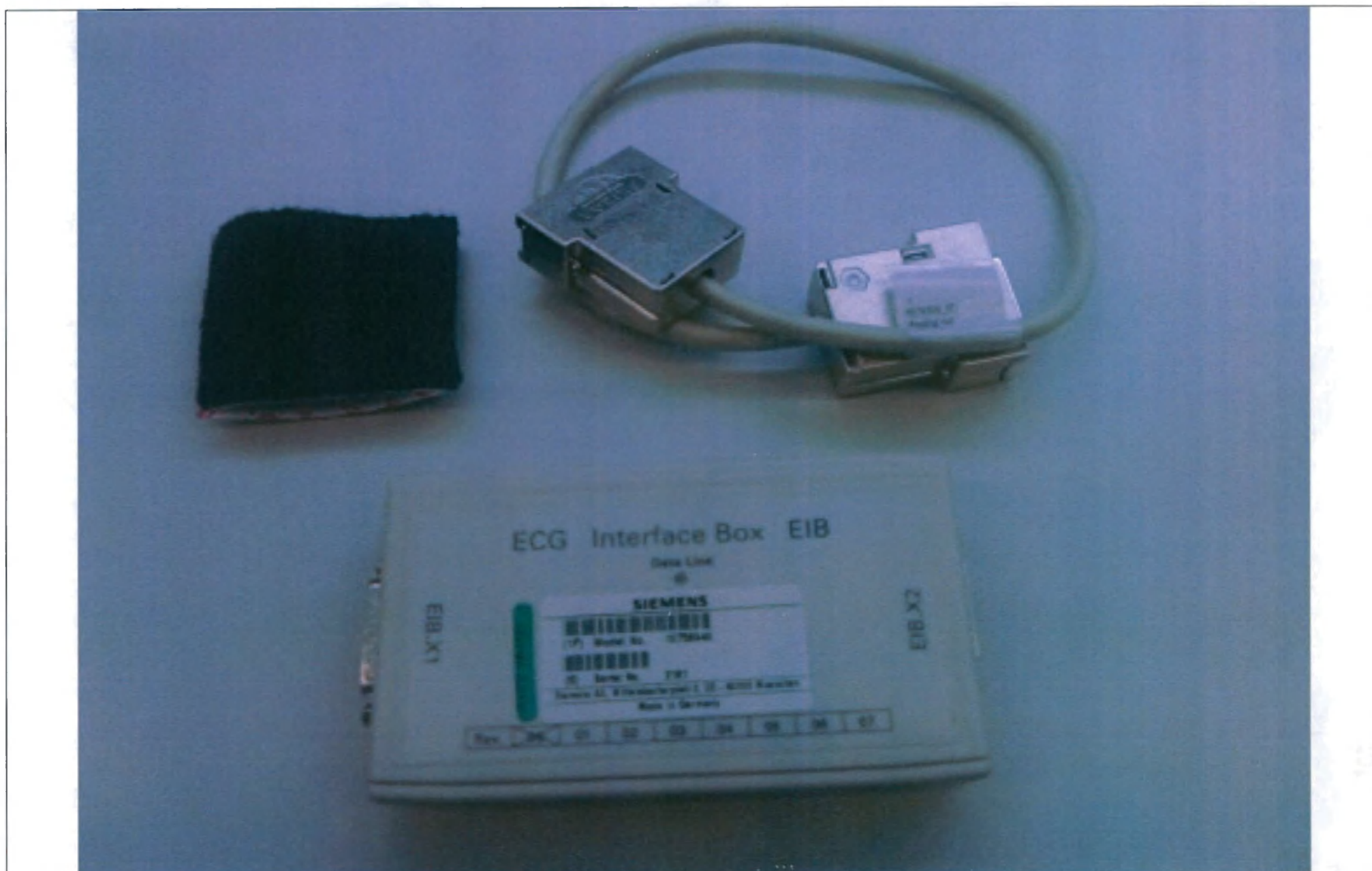
31.2 Комплект подключения системы Sensis: кабель-адаптер, блок подключения ЭКГ.
