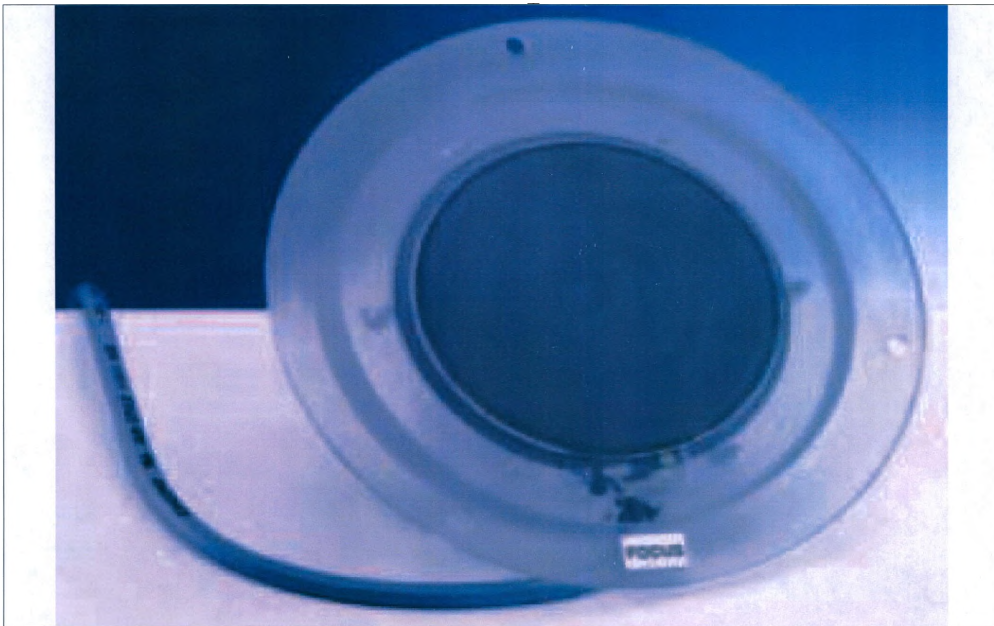
19.3 Камера для измерения дозы DIAMENTOR K2S.
