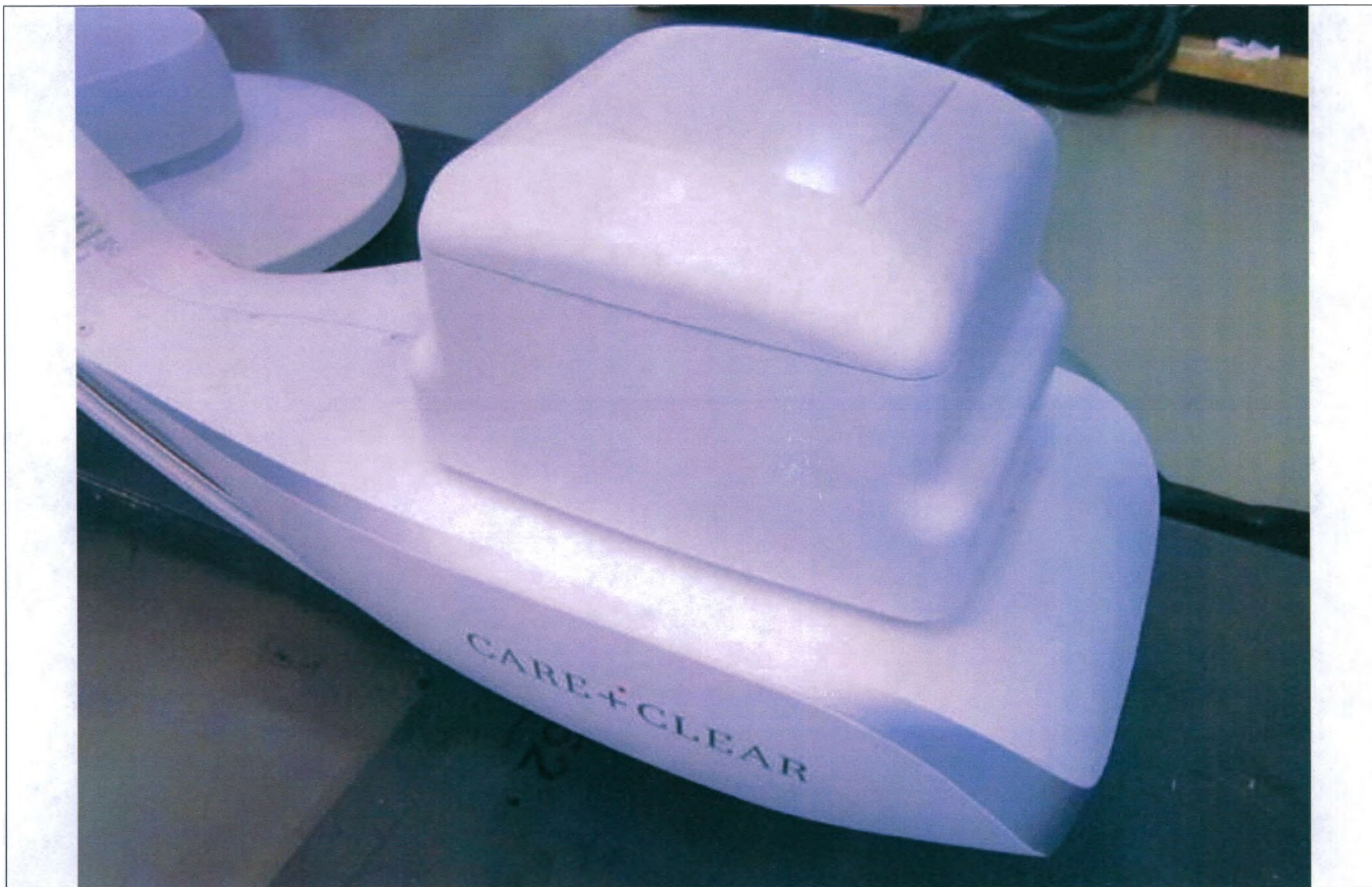
3.1 Блок рентгеновской трубки с первичным коллиматором.
