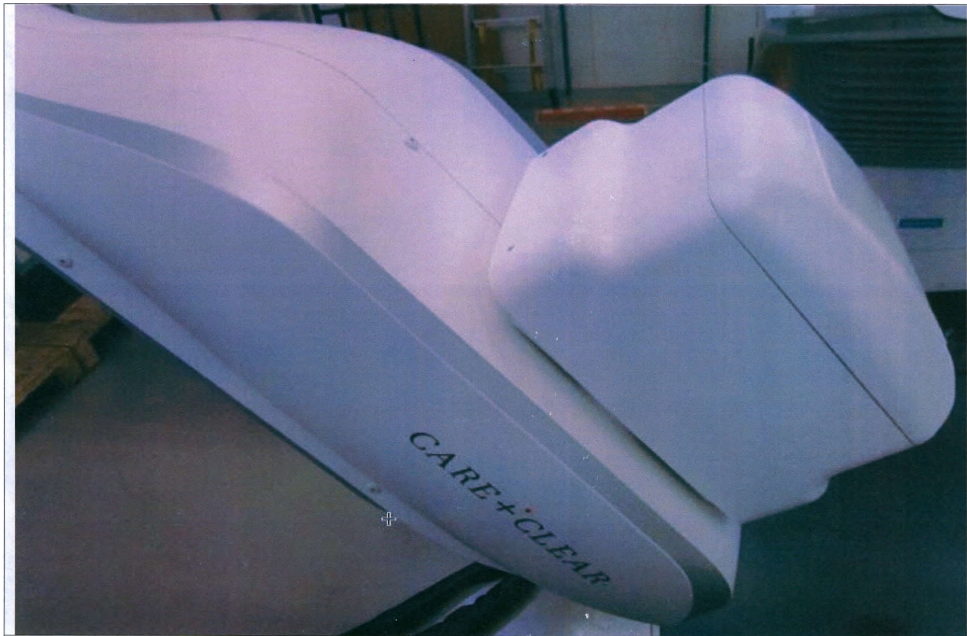
2. Блок рентгеновской трубки с первичным коллиматором.
