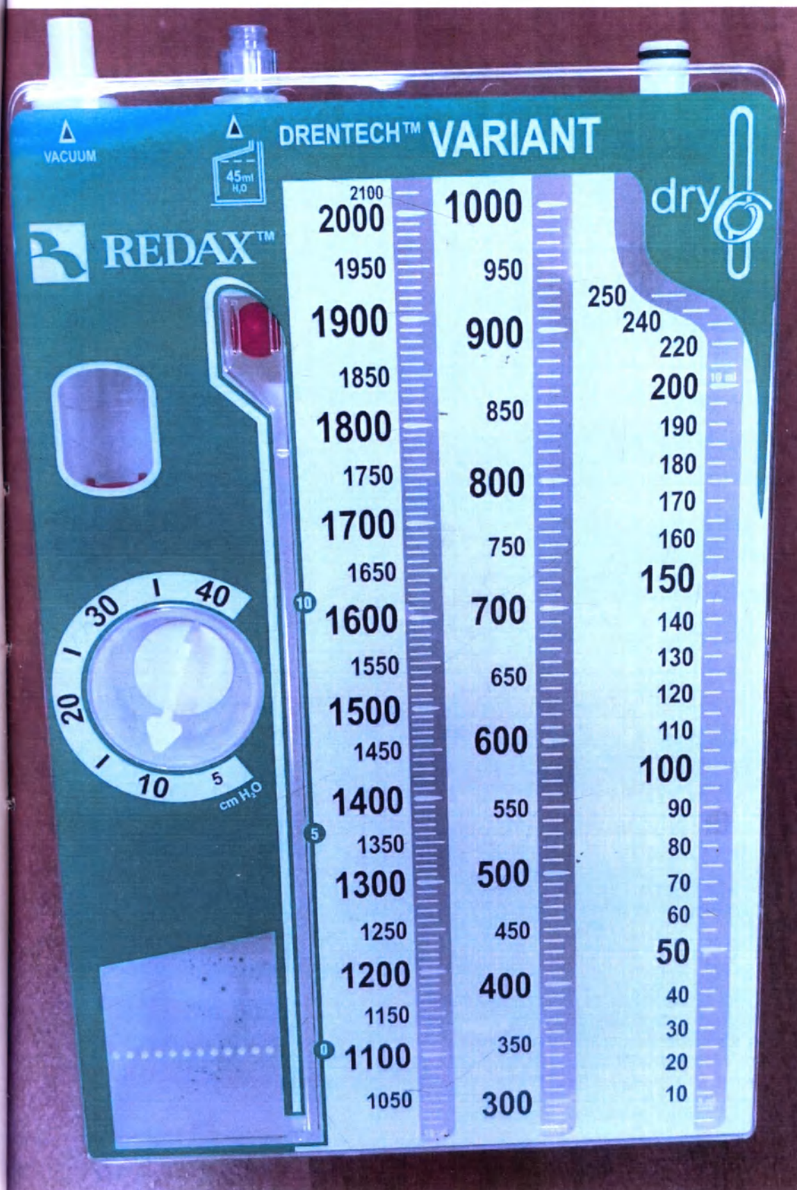
устройство дренажное VARIANT 3-х камерное с одной дренажной трубкой
