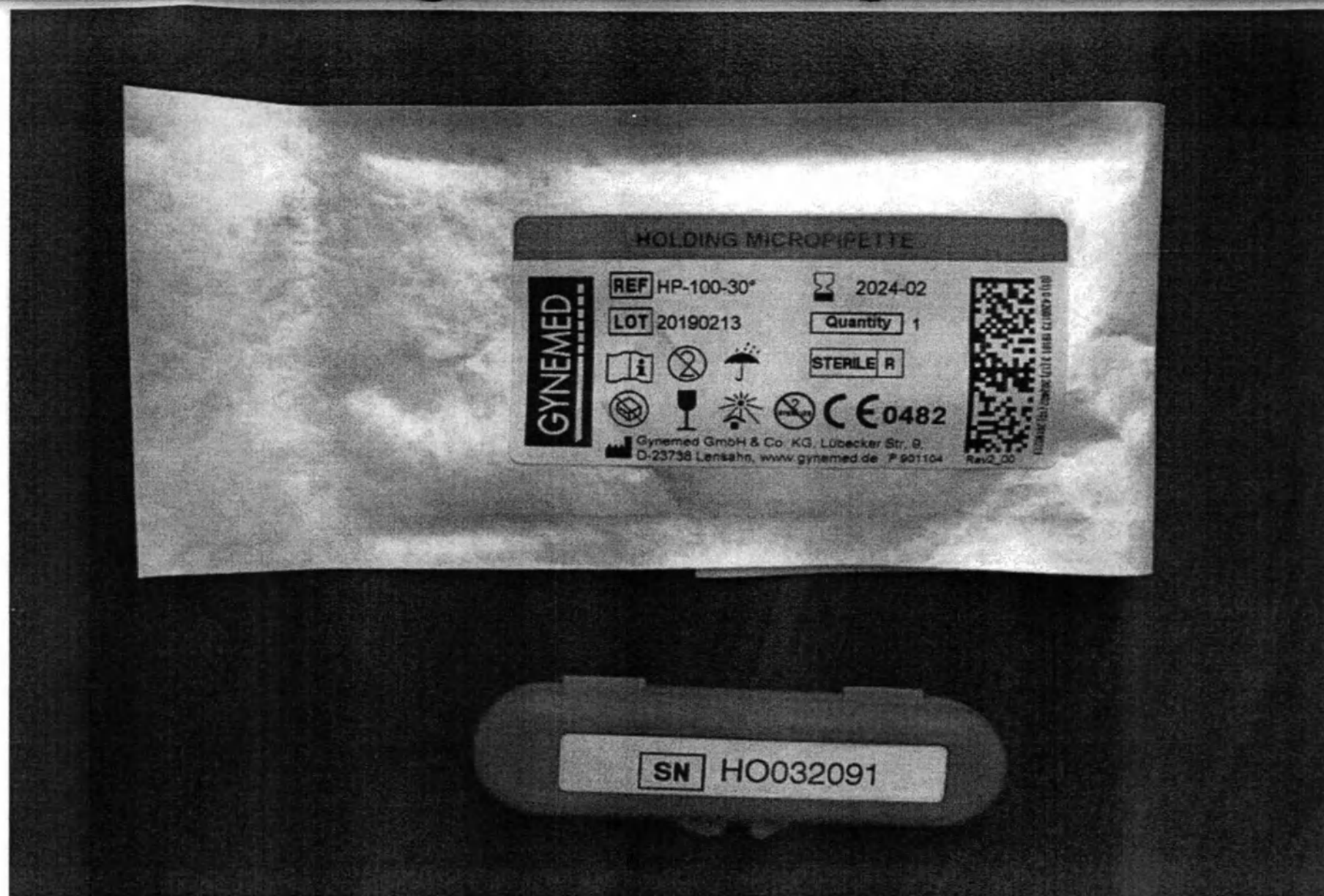
Холдинговая микропипетка (Holding), внешний диаметр 100 мкм, угол наклона 30°. Пластиковый футляр, индивидуальная упаковка (блистер).
