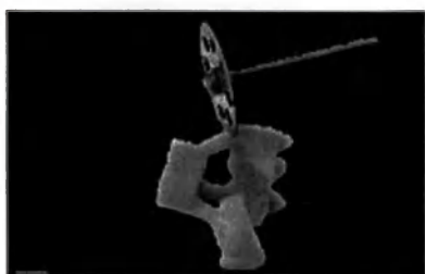
1 пресс-канал отделить с помощью алмазного диска.
