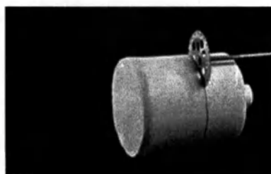
2. Сепарационным диском прорезать паковочную массу вокруг по маркировке.
