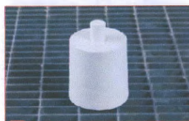
8 После окончания программы прессования поместите ополку в защищенное место для охлаждения.
