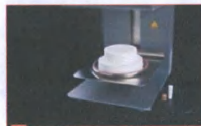
3 Подготовить холодный плунжер и холодную заготовку желаемого цвета.
