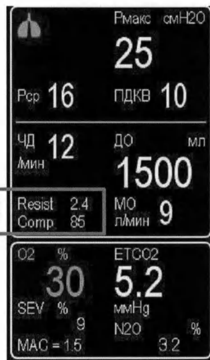
Рис. 35 Поле значений резистанса и комплаенса на дисплее управления
