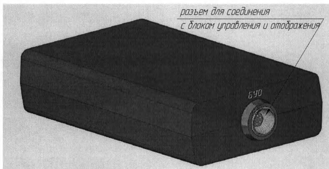
Рис. 20. Блок съема энцефалограммы.
