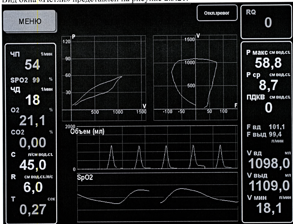
Рисунок 2.3.21 – Окно «Петли» в режиме «МОНИТОРИНГ»
