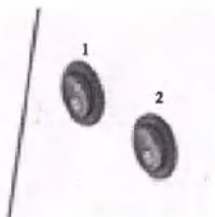
Рисунок 14 – Выключатель электропитания и вентилятора облучателя где 1 – выключатель электропитания; 2 – выключатель вентилятора
