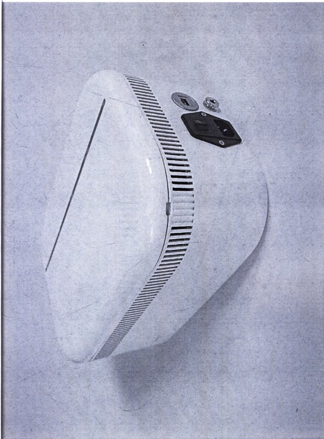
Блок управления и электропитания. Вид слева сбоку: кнопка вкл./выкл., разъем для Кабеля сетевой 220 В, разъем для информационного кабеля Ethernet, разъем для кабеля кнопки аварийного останова
