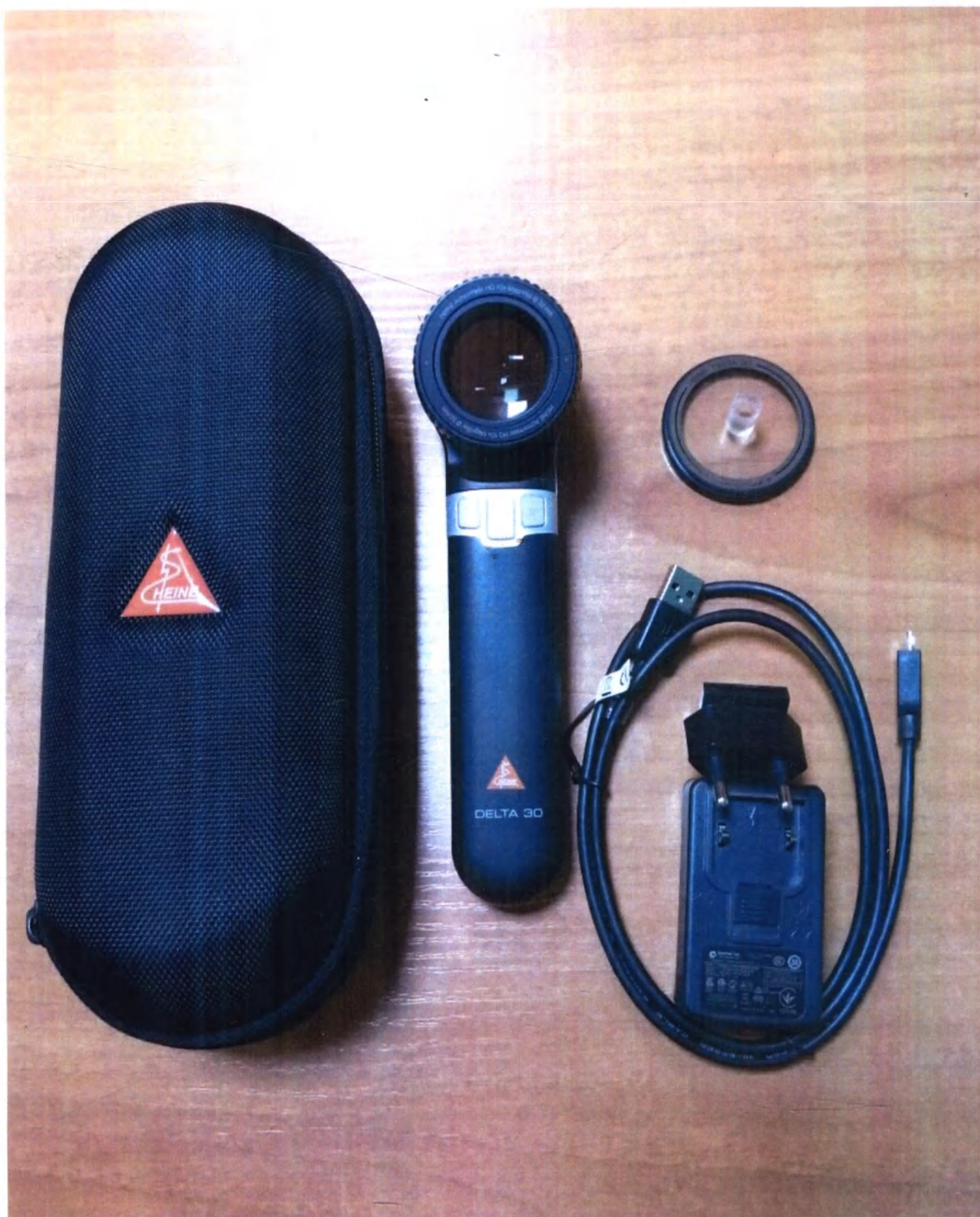
Фото 7. Футляр для хранения. Блок дерматоскопа основной с платой контактной со шкалой. Плата контактная малая. Кабель соединительный. Вилка штепсельная для адаптера сетевого. Адаптер сетевой.
