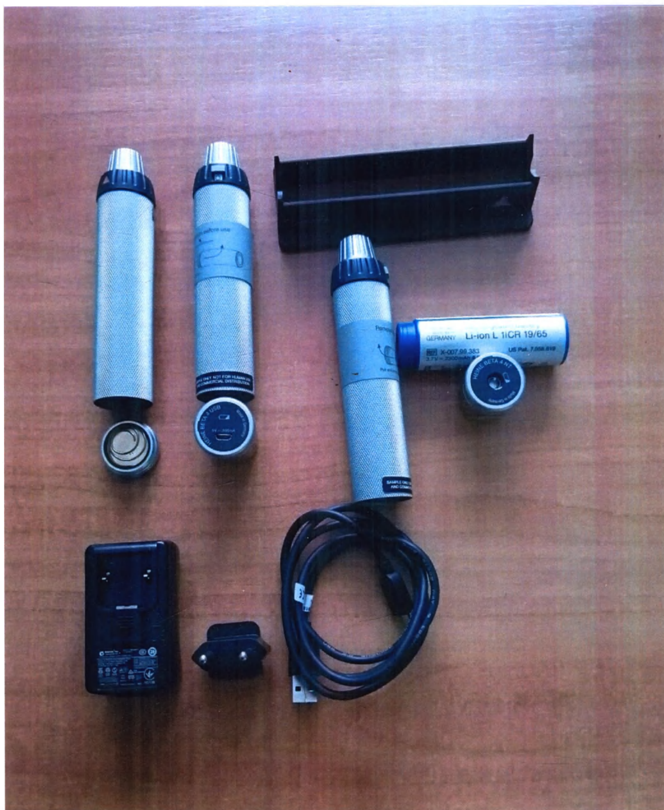
Фото 2. Рукоятка батарейная БЕТА. Модуль нижний для рукоятки БЕТА. Рукоятка перезаряжаемая БЕТА 4 USB. Модуль нижний для рукоятки БЕТА 4 USB. Подставка для рукоятки. Рукоятка перезаряжаемая БЕТА 4 NT. Модуль нижний для рукоятки БЕТА 4 NT. Аккумулятор Li-ion 3,7В. Адаптер сетевой. Кабель соединительный для рукоятки. Вилка штепсельная для адаптера сетевого.
