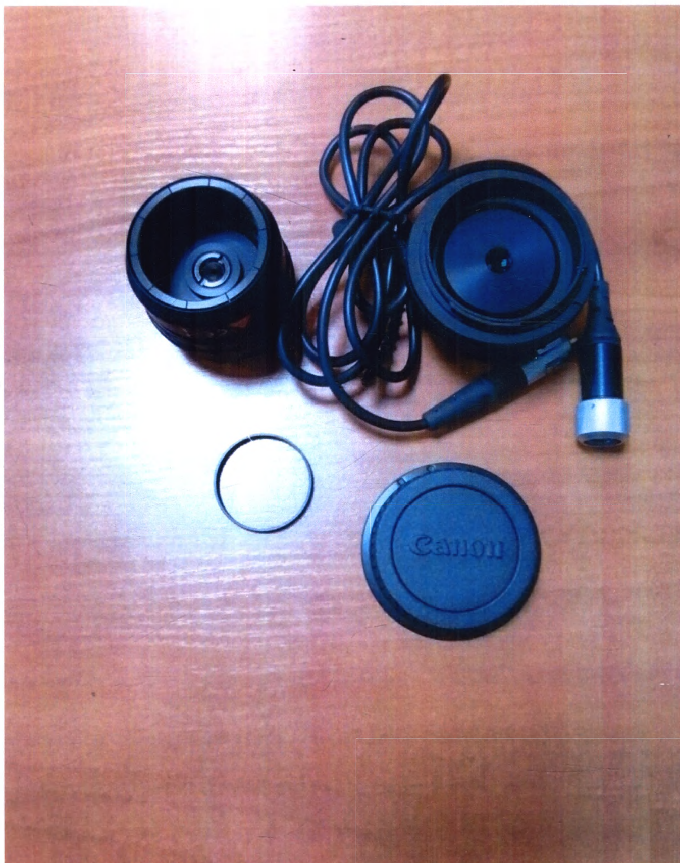
Фото 4. Фотоадаптер SLR для фотоаппарата Canon. Фотоадаптер SLR для фотоаппарата Nikon. Кольцо дистанционное для крепления фотоадаптера. Кабель соединительный для камеры.
