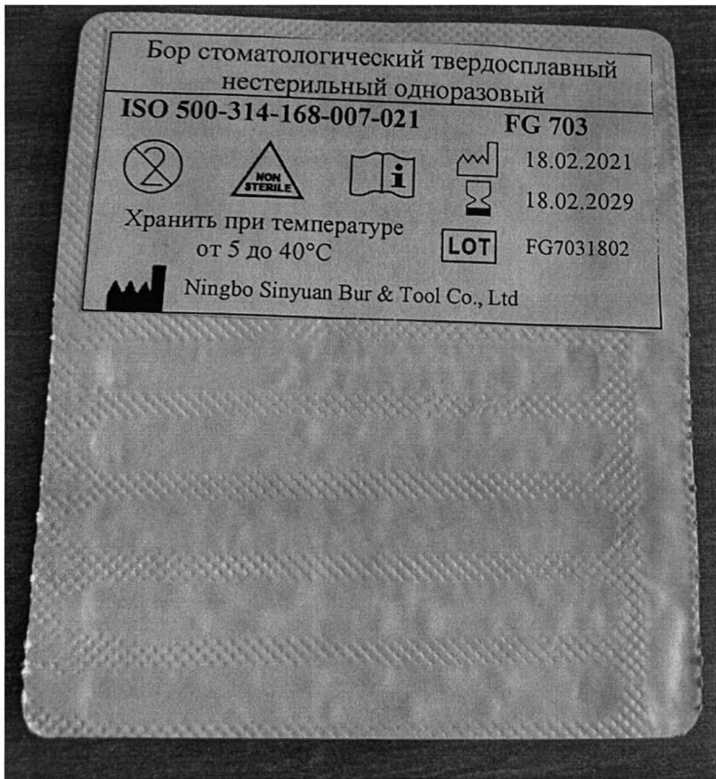
Рисунок 216 – Маркировка упаковки Бор стоматологический твердосплавный нестерильный одноразовый, восьмигранный, с хвостовиком типа FG 703, форма рабочей части: конусная фиссурная головка, код 500-314-168-007-021 LOT FG7031802, срок годности 18.02.2029
