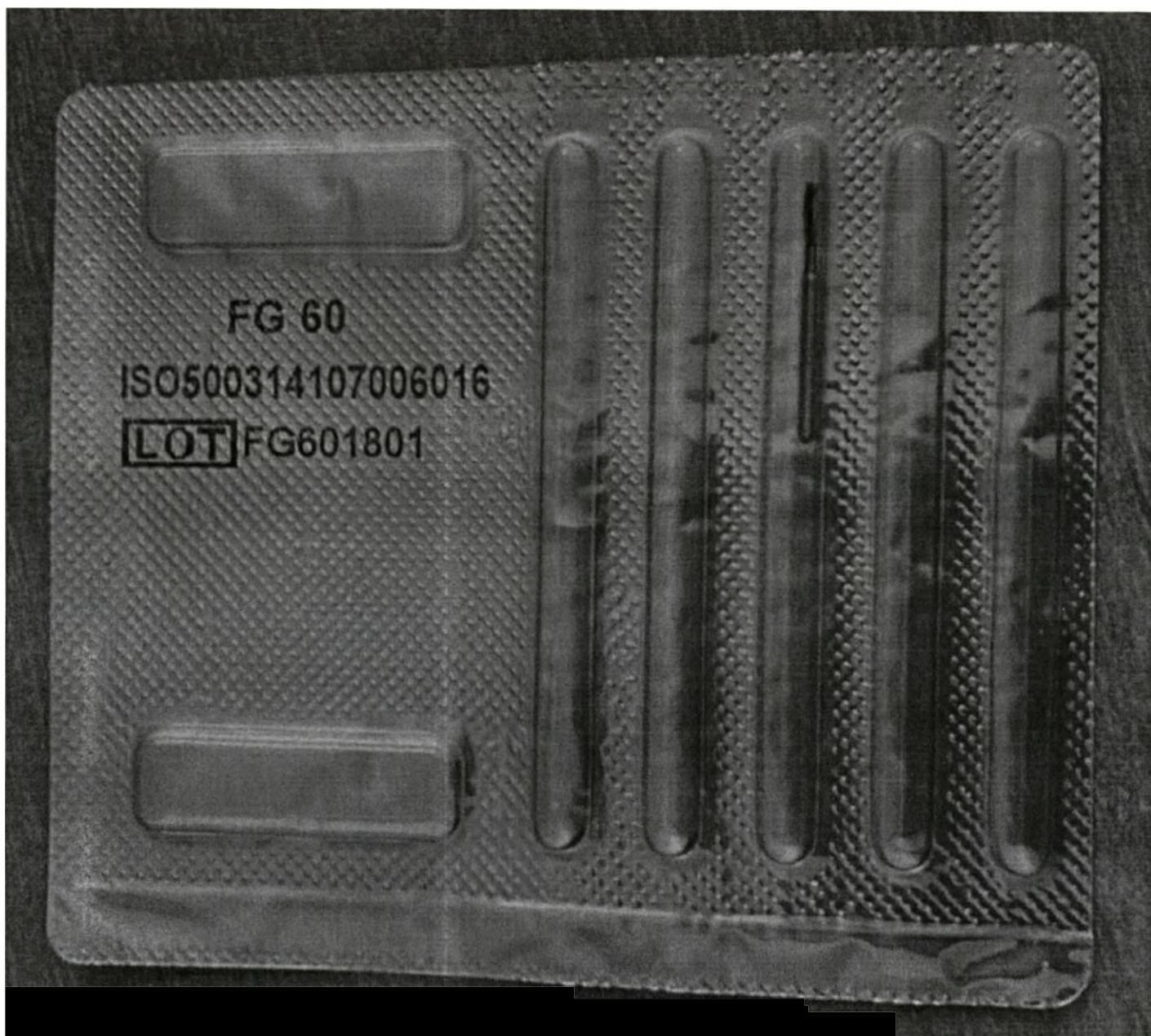
Рисунок 5 – Бор стоматологический твердосплавный нестерильный одноразовый, шестигранный, с хвостовиком типа FG 60, форма рабочей части: прямая фиссурная головка, код 500-314-107-006-016. LOT FG601801, срок годности 23.02.2029, в упаковке
