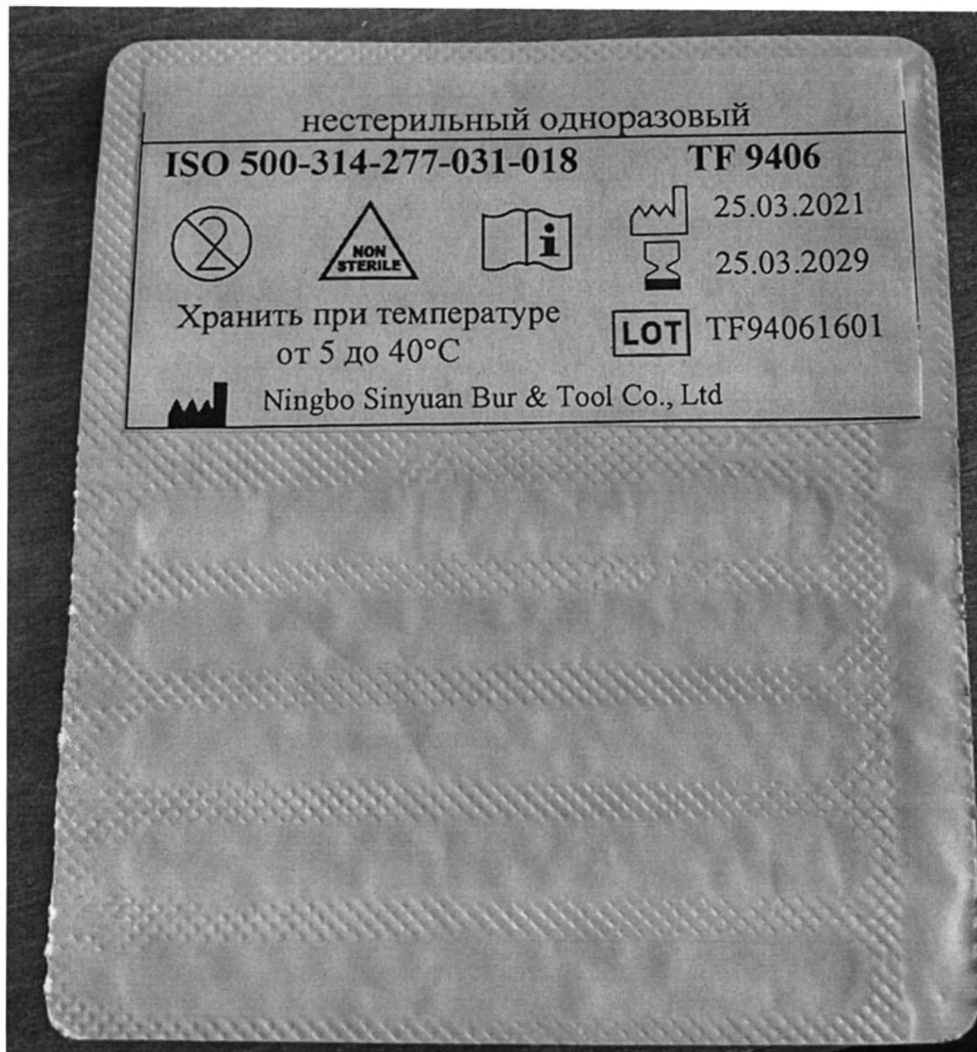
Рисунок 346 – Маркировка упаковки Бор стоматологический твердосплавный нестерильный одноразовый, тридцатигранный, с хвостовиком типа TF 9406, форма рабочей части: яйцевидная головка, код 500-314-277-031-018. LOT TF94061601, срок годности 25.03.2029
