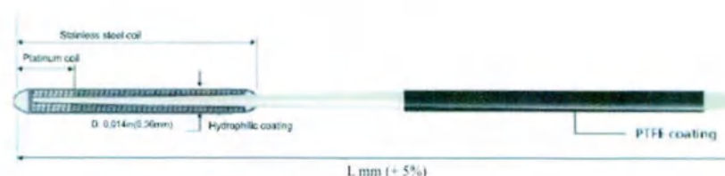
Рисунок 3. Схематичный чертеж проводника внутрисосудистого РТСА (группы P), прямой кончик/
