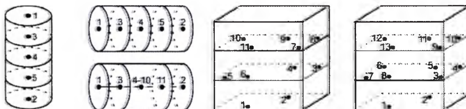
Рис. 1 Расположение контрольных точек в паровых стерилизаторах
