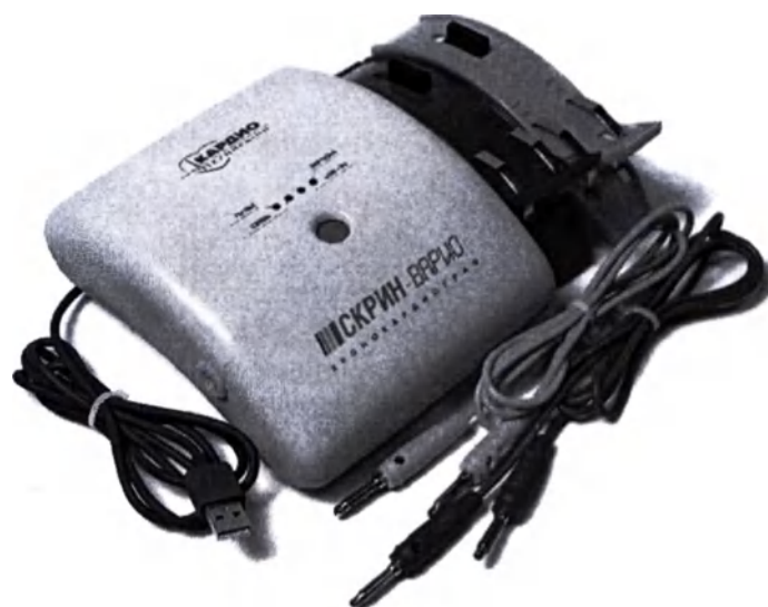
Рис. 7 Хронокардиограф «Скрин-Варио» в комплекте с основными комплектующими: кабелями для электродов, контактными электродами и шнуром USB-micro USB.
