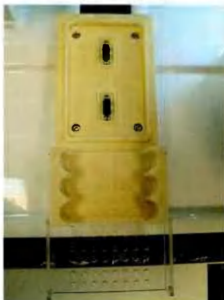
Рисунок 30 - Установить резервуары в соответствующие им положения на основании позиционера
