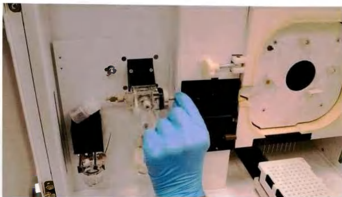
Рисунок 96 - Вставить трубку с винтом в блок заполнения полимером
