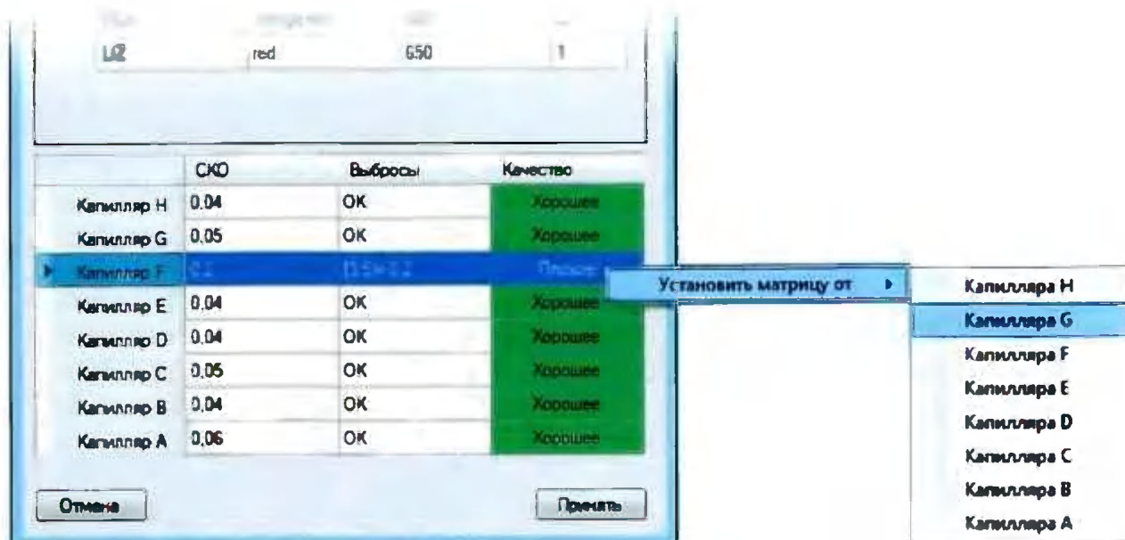
Рисунок 55 – Установка матрицы от другого капилляра
