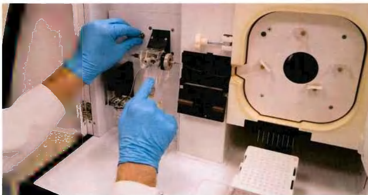
Рисунок 12 - Зафиксировать панель блока заполнения полимером, закрутив до упора винт.
