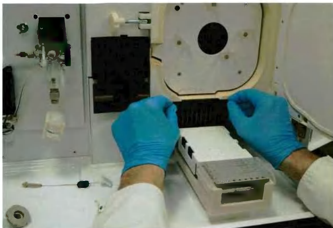
Рисунок 6 - Защелкнуть фиксаторы планки линейки капилляров.
