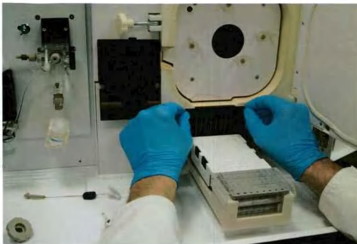
Рисунок 6 - Защелкнуть фиксаторы планки линейки капилляров.
