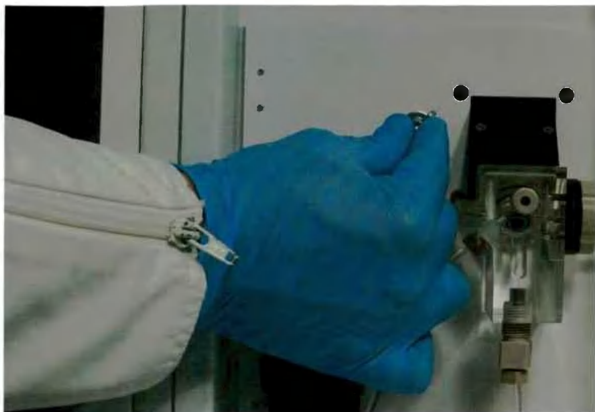
Рисунок 9- Отвернуть винт против часовой стрелки и выдвинуть блок заполнения полимером
