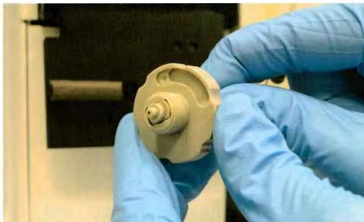
Рисунок 8 - Вставить трубку линейки капилляров в винт.
