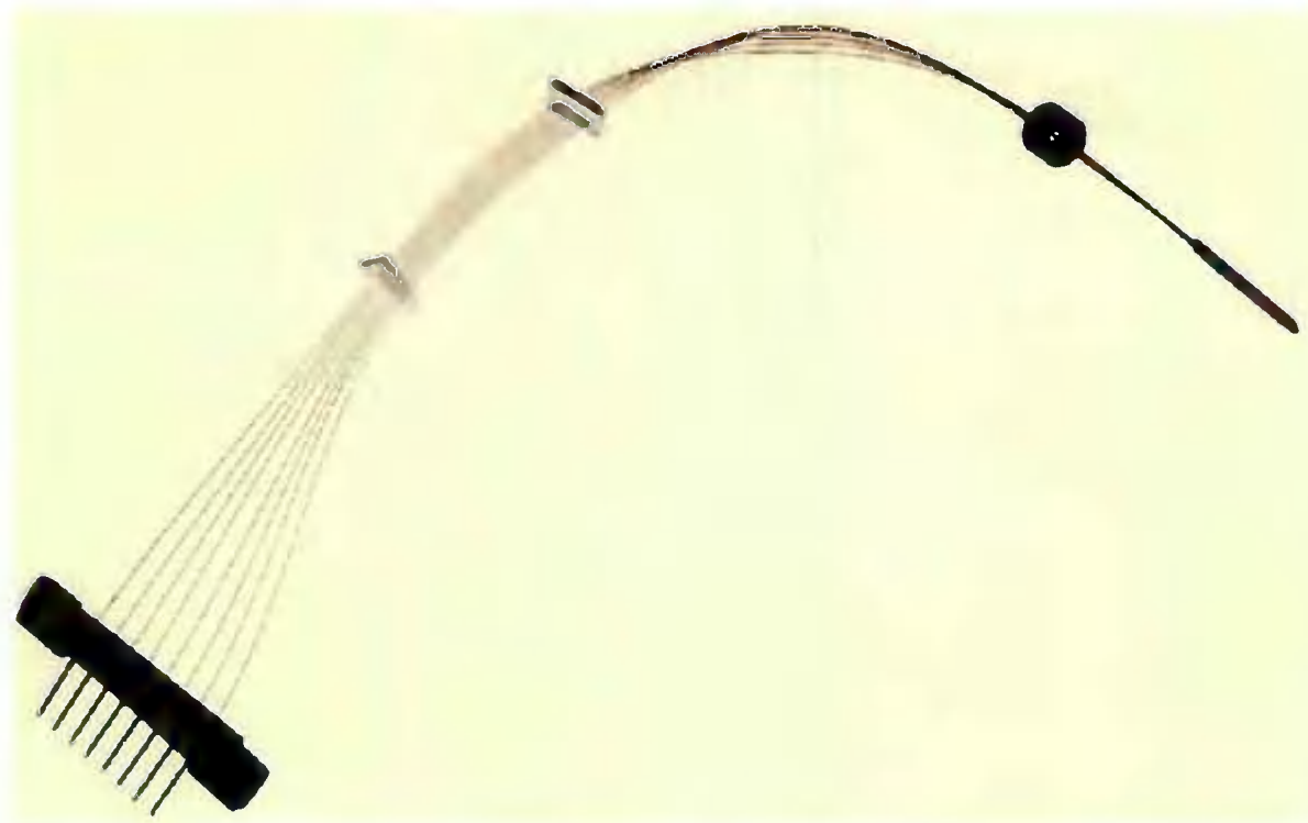
Рисунок 6 - Линейка из восьми капилляров
