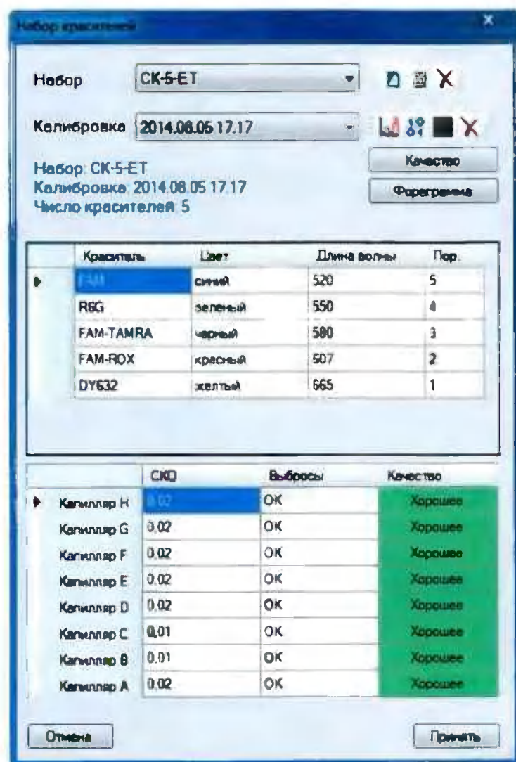
Рисунок 56- Хорошее качество спектральной калибровки
