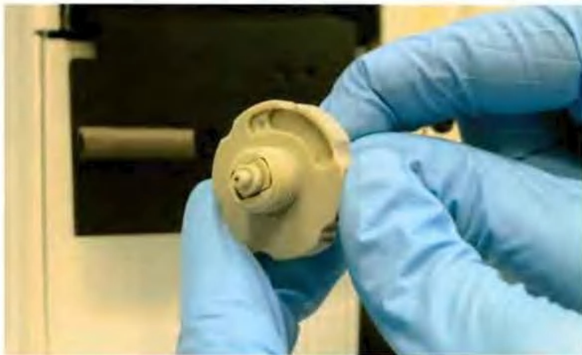
Рисунок 8 - Вставить трубку линейки капилляров в винт.
