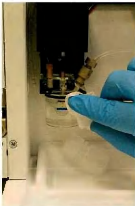
Рисунок 15 - Удаление капель буфера
