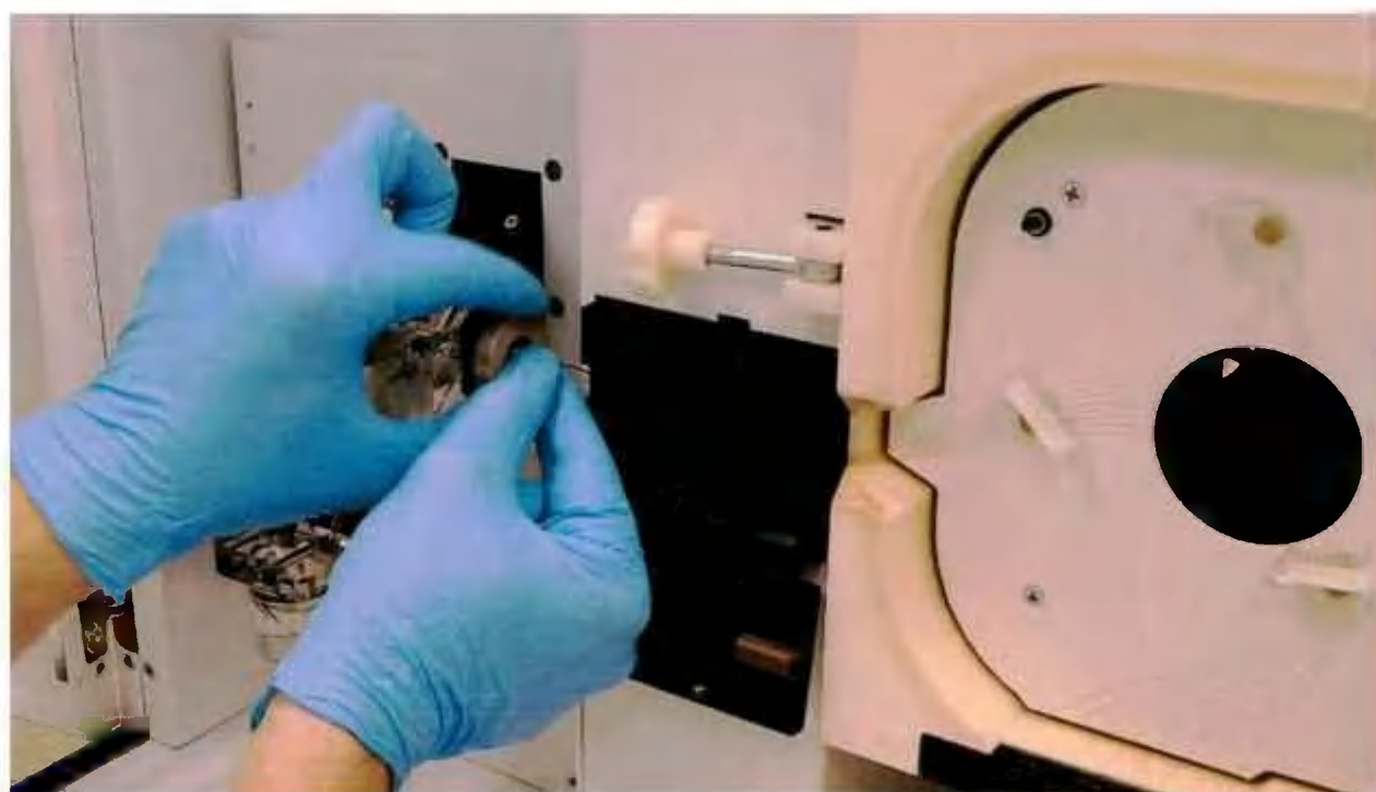
Рисунок 10 - Плотно закрутить фиксирующий винт
