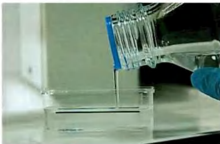
Рисунок 19 - Заполнить резервуары соответствующими жидкостями (буфером или деионизированной водой) до уровня черной линии
