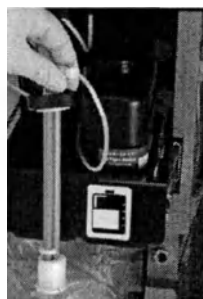
Рисунок 1.75: Датчик уровня пре-триггера
