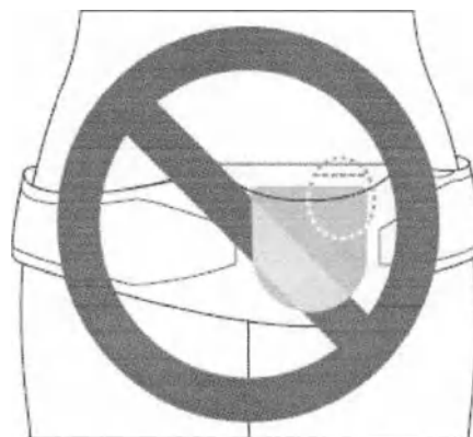
Рисунок 4. Неправильное расположение зарядного устройства (обведено серым) над стимулятором (пунктирная линия)
