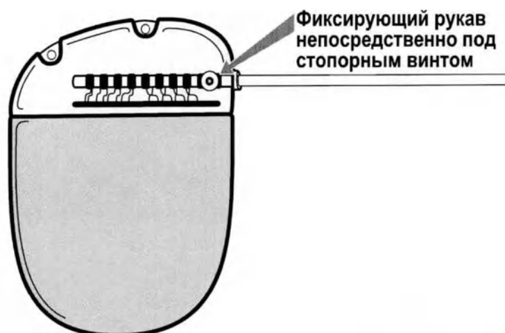
Рисунок 32. Совмещение контактов удлинителя электрода в порте ИГИ для ГСМ
