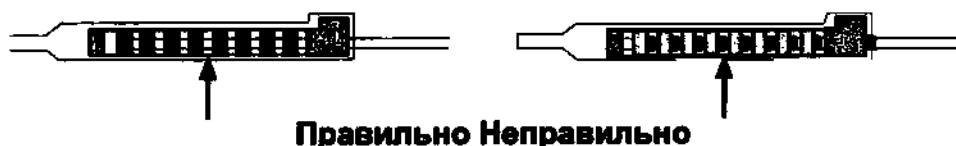
Рисунок 31. Совмещение электрода для ГСМ в разъеме удлинителя электрода
