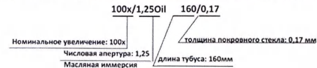
Рисунок 2. Маркировка объектива
