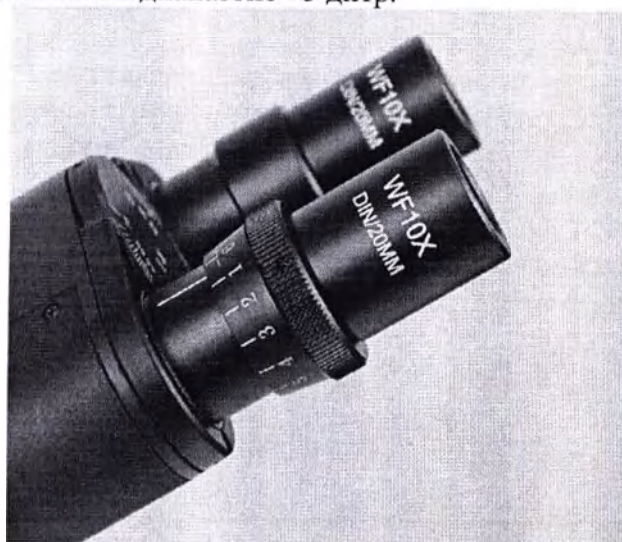
Рисунок 8. Кольцо диоптрийной наводки
