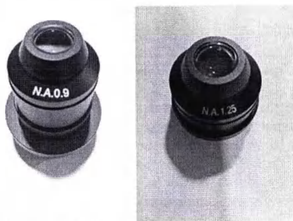
Рисунок 13. Конденсоры тёмного поля
