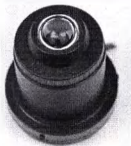
Рисунок 9. Конденсор Аббе иммерсионный 1,25
