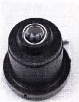
Рисунок 9. Конденсор Аббе иммерсионный 1,25
