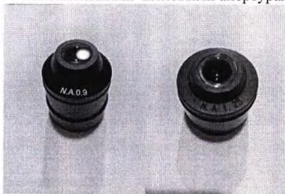
Рисунок 11. Конденсоры светлого поля
