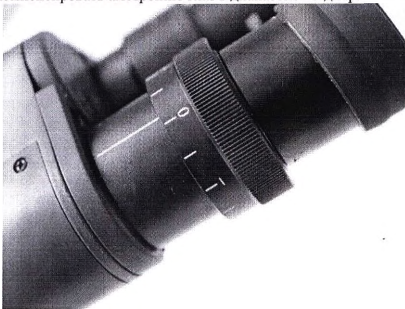
Рисунок 10. Кольцо диоптрийной наводки
