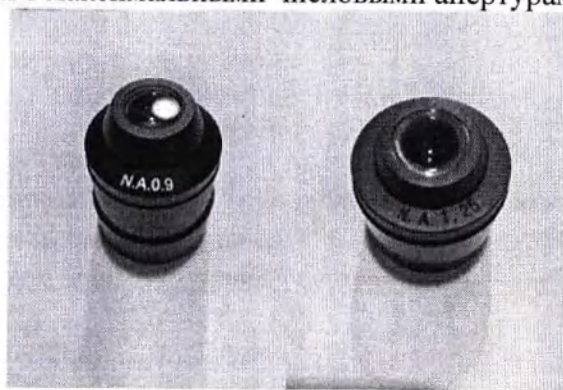
Рисунок 11. Конденсоры светлого поля
