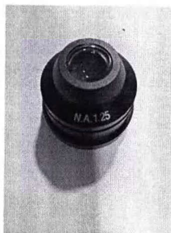
Рисунок 11. Конденсоры тёмного поля
