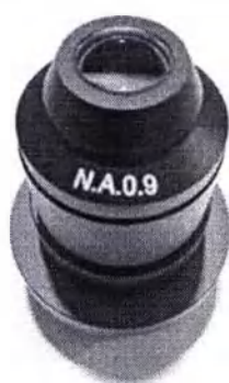
Рисунок 11. Конденсоры тёмного поля
