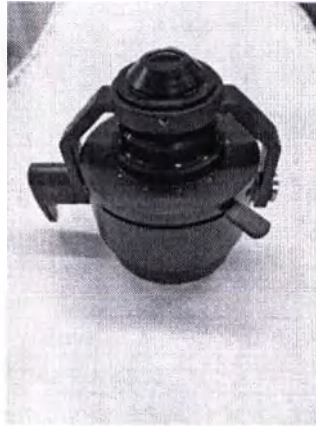
Рисунок 10. Конденсор тёмного поля
