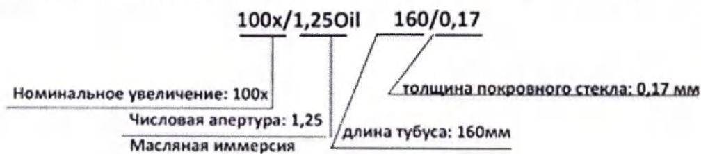
Рисунок 2. Маркировка объектива
